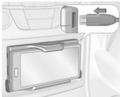
Connettere lo smartphone al porta telefono utilizzando il cavo di connessione compatibile. Sono disponibili come accessori diverse versioni del cavo di collegamento.
