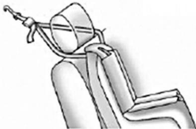
Se la posizione di seduta posteriore esterna che si sta utilizzando viene fissata a un sedile con poggiatesta regolabile e la cintura di trattenuta è doppia, sollevare il poggiatesta e passare la cintura attorno alle barre di regolazione del poggiatesta stesso.
