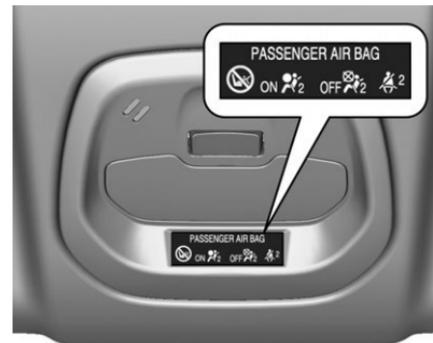
Se la spia OFF si illumina per circa 60 secondi dopo l'accensione del quadro, il sistema airbag del passeggero anteriore si gonfierà in caso d'incidente. Lo stato viene mantenuto fino alla successiva modifica.
