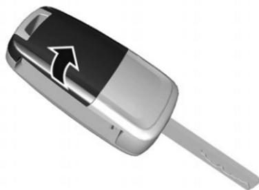
Estendere la chiave e aprire l'unità. Sostituire la batteria (di tipo CR 2032) prestando attenzione alla posizione di installazione. Chiudere l'unità e sincronizzarla.
