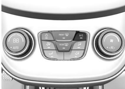
Premere A/C per inserire il raffreddamento. L'attivazione è indicata dal LED sul pulsante. Il raffreddamento funziona solamente con il motore acceso e la ventola
