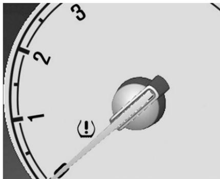
Il rilevamento di una bassa pressione degli pneumatici viene segnalato dalla spia (⚠). *Spia sistema di monitoraggio pressione pneumatici* ⇨ 76.
