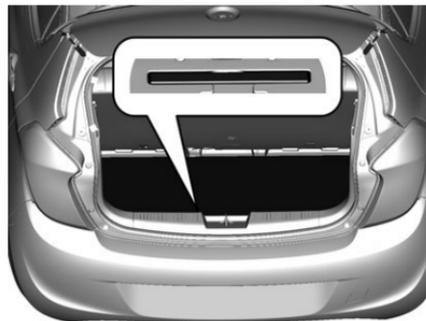
Riporre il triangolo d'emergenza nella scatola porta attrezzi del veicolo sotto la copertura del pianale nel vano di carico.
