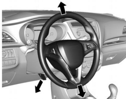
Sbloccare la leva, regolare la posizione del volante, quindi riportare la leva in posizione iniziale e accertarsi che sia completamente bloccata.
