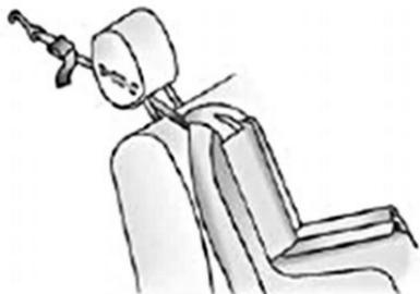
Se la posizione di seduta posteriore esterna che si sta utilizzando viene fissata a un sedile con poggiatesta regolabile e la cintura di trattenuta è singola, sollevare il poggiatesta e passare la cintura sotto di esso tra le barre di regolazione del poggiatesta stesso.
