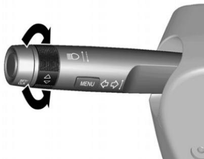
Ruotare la manopola di regolazione per selezionare un'opzione di menu o per impostare un valore numerico.
