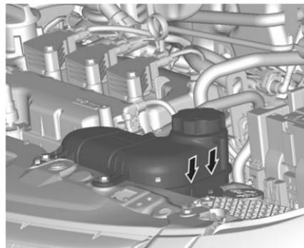
Quando il sistema di raffreddamento è freddo, il livello del liquido di raffreddamento dovrebbe essere al di sopra della tacca di riempimento.
