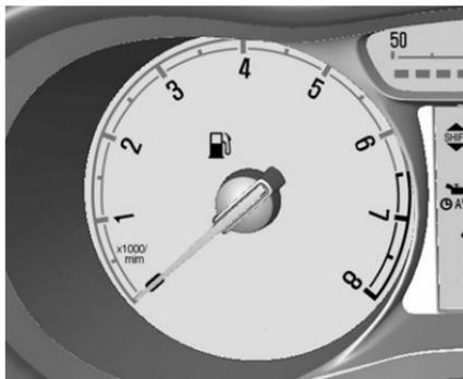
Se il livello nel serbatoio è basso, si accende la spia
