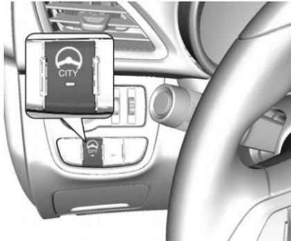
Premere "CITY" con il motore in funzione. Il sistema funziona da fermo fino a una velocità di 60 km/h e in retromarcia. Oltre questa velocità il sistema passa alla modalità normale. Quando attivata, la modalità Città si attiva automaticamente sotto le 60 km/h.
