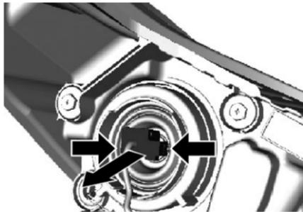
3. Avvicinare entrambi i fermi premendo e staccare il connettore a spina dalla lampadina.
