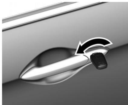
Sbloccare manualmente la portiera del conducente girando la chiave nella serratura. Accendere il quadro e premere il pulsante della chiusura centralizzata per sbloccare tutte le portiere e il vano di carico.
