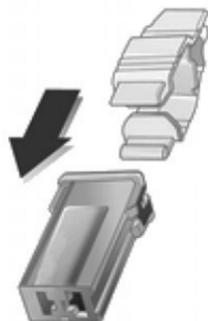
Posizionare l'estrattore per fusibili sulla sommità o sul lato del fusibile, a seconda del tipo, ed estrarre il fusibile.
