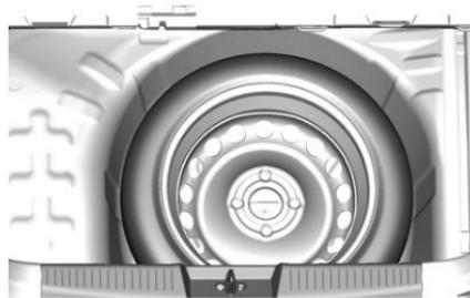
La ruota di scorta è situata nel vano di carico sotto la copertura del pianale. E' fissata nell'incavo mediante un bullone a galletto.
