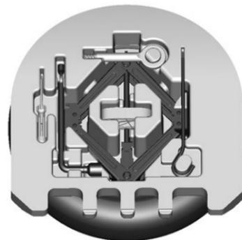
Il martinetto e gli attrezzi del veicolo sono posizionati nel vano di carico.
