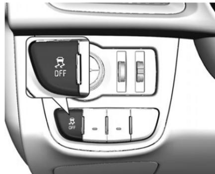
Il controllo della trazione può essere disattivato quando è richiesto lo slittamento delle ruote motrici: Premere
