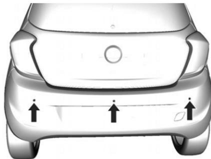
Con il sistema di ausilio al parcheggio posteriore è più facile parcheggiare, grazie alla possibilità di calcolare la distanza tra il veicolo e gli ostacoli posteriori. Il sistema informa e avvisa il conducente tramite segnalazioni acustiche e indicazioni sul display.
