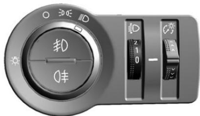
Per regolare la profondità delle luci in base al carico del veicolo e non abbagliare i conducenti dei veicoli in avvicinamento: ruotare la manopola
