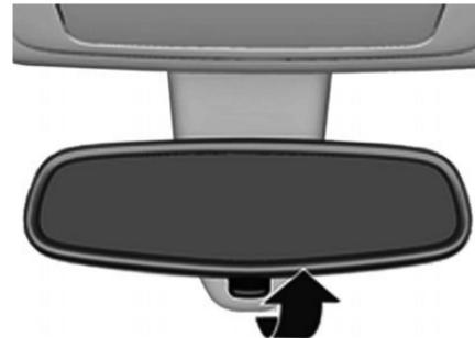
Per ridurre l'abbagliamento, agire sulla leva nella parte inferiore del corpo dello specchio.
