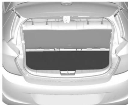
Il kit di riparazione dei pneumatici si trova nella cassetta porta attrezzi sotto alla copertura del pianale nel vano di carico.
