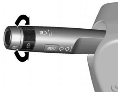
Per azionare il contachilometri parziale, ruotare la rotella di regolazione nella leva dell'indicatore di direzione.
