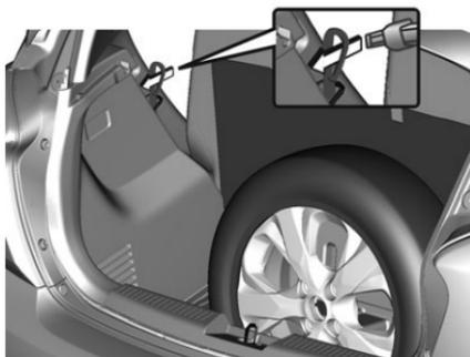
3. Posizionare l'estremità con anello della cinghia dalla scatola degli attrezzi facendola passare attraverso la chiusura dello schienale del sedile.
