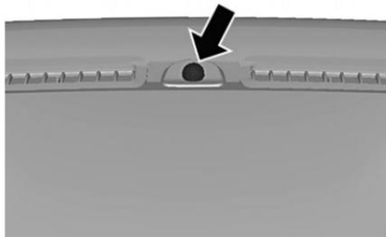
Il LED di stato è integrato nel sensore sulla parte superiore del quadro strumenti.
