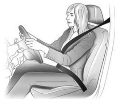
Le cinture di sicurezza sono bloccate durante le accelerazioni e decelerazioni brusche del veicolo, per mantenere gli occupanti dell'auto in posizione corretta. In questo modo il rischio di lesioni si riduce notevolmente.
