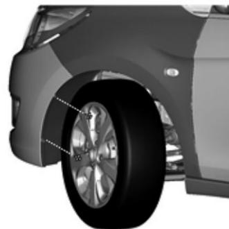
1. Inclinare la ruota e rimuovere 2 dadi a spinta sul rivestimento esterno della stessa.
