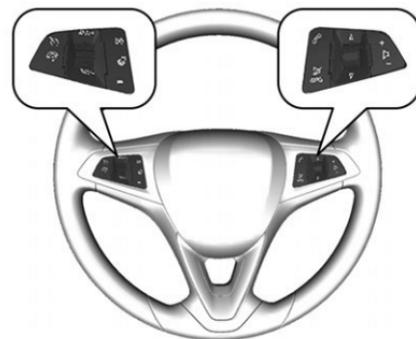
È possibile controllare il sistema Infotainment, il regolatore della velocità e il telefono cellulare collegato tramite i comandi al volante.
