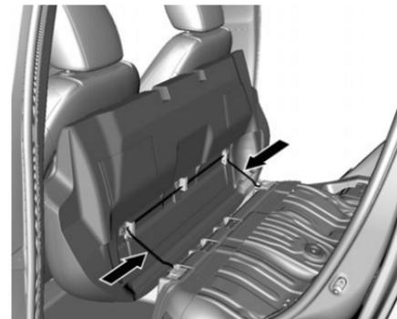
Per rimuovere la seduta del sedile posteriore, spingere le cerniere in direzione della freccia.
