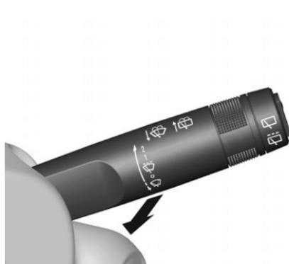
Tirare la leva. Il liquido di lavaggio viene spruzzato sul parabrezza e il tergicristallo effettua alcuni passaggi.
