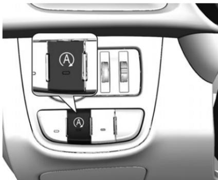
Disattivare il sistema start-stop manualmente premendo il pulsante. La disattivazione è indicata dallo spegnimento del LED sul pulsante.
