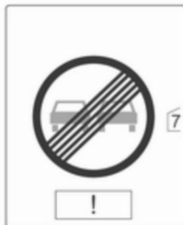
Un punto esclamativo in un riquadro indica che è stato rilevato un segnale supplementare che il sistema non è in grado di riconoscere.
