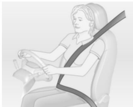
Le cinture di sicurezza sono bloccate durante le accelerazioni e decelerazioni brusche del veicolo, per mantenere gli occupanti dell'auto in posizione corretta. In questo modo il rischio di lesioni si riduce notevolmente.
