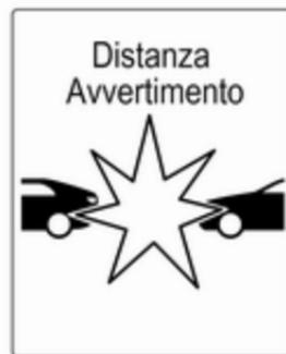
Quando la distanza con un veicolo in movimento che precede diventa troppo breve o quando ci si avvicina ad un altro veicolo troppo rapidamente e una collisione è imminente, il simbolo di allarme collisione appare nel Driver Information Centre.
