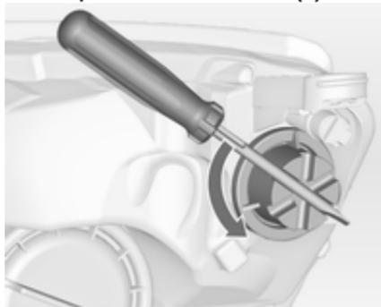
1. Ruotare il coperchio (3) in senso antiorario e rimuoverlo. Ruotare il coperchio utilizzando un cacciavite.
