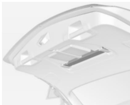
Ripiegare le cinghie. Riporre il triangolo di emergenza nell'apposito spazio dietro le cinghie sulla parte interna del portellone posteriore.
