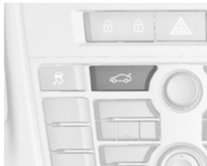
Se le portiere sono state bloccate tramite la chiusura centralizzata, il baule non si apre premendo il pulsante
