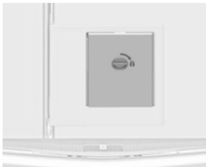
Una volta chiuso il coperchio può essere fissato dall'interno del vano di carico. Ruotare la manopola di 90°:
