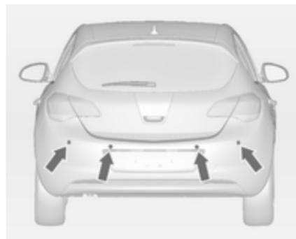
Il sistema è dotato di quattro sensori di parcheggio ad ultrasuoni ubicati nei paraurti posteriori.
