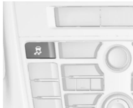
Il controllo della trazione può essere disattivato quando è richiesto lo slittamento delle ruote motrici:
