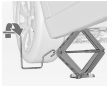
Attaccare la maniglia del martinetto e con il martinetto correttamente allineato ruotare la maniglia finché la ruota non è sollevata dal suolo.
