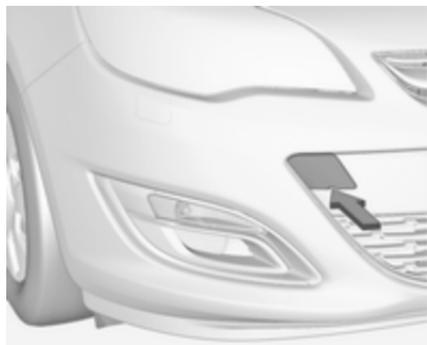
Inserire un cacciavite nella fessura sulla parte inferiore del cappello. Sganciare il coperchio muovendo con cautela il cacciavite verso il basso. L'occhiello di traino è riposto insieme agli attrezzi per il veicolo ⇨ 273.
