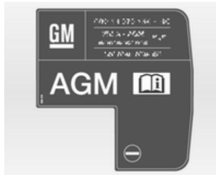
È possibile identificare una batteria AGM dall'etichetta presente sulla batteria. Si raccomanda l'uso di una batteria veicolo originale Opel.
