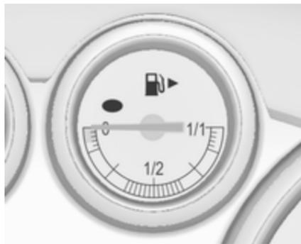
Indica il livello del carburante o il livello del gas nel serbatoio, a seconda della modalità di funzionamento.
