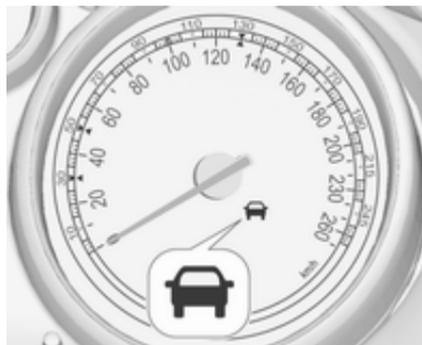
L'indicatore veicolo davanti acceso verde
