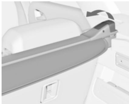
Aprire la copertura del vano di carico. Tirare la leva di sblocco sul lato destro verso l'alto e tenere in posizione. Sollevare la copertura a partire dal lato destro e sganciarla dai fermi.
