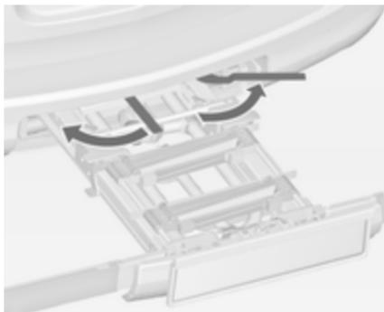
Portare le leve di bloccaggio di lato il più possibile.
