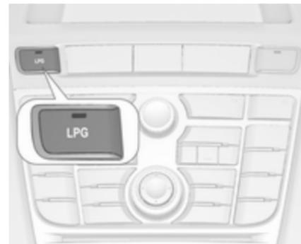
Premere il pulsante **LPG** per passare dal funzionamento a benzina a quello a gpl e viceversa. Lo stato del LED
