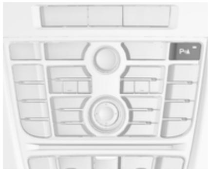
Il sistema di ausilio al parcheggio anteriore-posteriore è dotato di pulsante **P** con un triangolo. Se il veicolo è anche dotato di dispositivo di assistenza al parcheggio avanzato (consultare la seguente descrizione a parte), il sistema è dotato di pulsante **P** con un triangolo e un rettangolo. In questo caso entrambi i sistemi saranno comandati tramite il pulsante **P** con un triangolo e un rettangolo.
