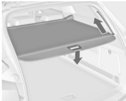
Premere la maniglia all'estremità della copertura verso il basso. La parte posteriore della copertura viene guidata automaticamente verso l'alto.
