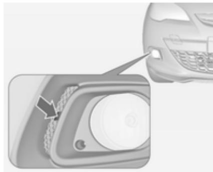
1. Disinnestare la copertura con un cacciavite nella cavità e rimuovere la copertura.
