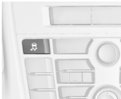
Per una guida a prestazioni elevate, è possibile disattivare separatamente i sistemi ESC e TC. È possibile selezionare le seguenti modalità:
