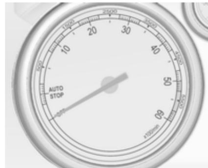
Indica la velocità di rotazione del motore.
