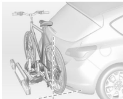
Allineare la bicicletta nel senso longitudinale del veicolo: allentare leggermente il supporto del pedale.
