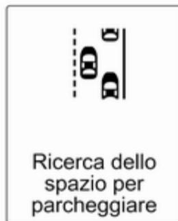
Se il veicolo passa accanto a una fila di veicoli con il sistema attivato, il dispositivo di assistenza al parcheggio avanzato inizia a cercare uno spazio di parcheggio adeguato. Al rilevamento di uno spazio adeguato, il sistema emette una segnalazione visiva sul Driver Information Centre e una acustica.
