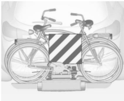
Si raccomanda di fissare un segnale di avvertimento alla bicicletta più esterna per aumentare la visibilità del carico.
