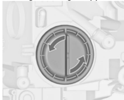
1. Ruotare il coperchio (1) in senso antiorario e rimuoverlo.
