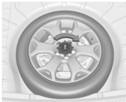
La ruota danneggiata deve essere riposta nel pozzetto della ruota di scorta con il lato esterno rivolto verso l'alto e fissata con il dado ad alette.
