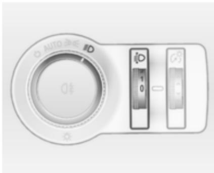
Per regolare la profondità delle luci in base al carico del veicolo e non abbagliare i conducenti dei veicoli in avvicinamento: ruotare la manopola
