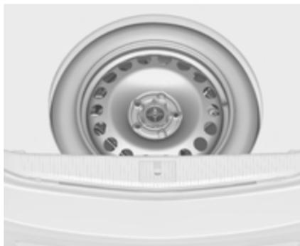
La ruota di scorta è situata nel vano di carico sotto la copertura del pianale. È fissata con un dado ad alette.
