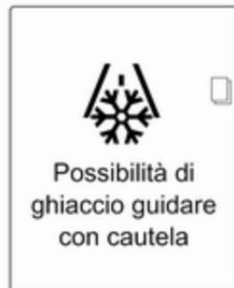
Se la temperatura esterna scende a 3 °C, un messaggio di avvertimento viene visualizzato nel Driver Information Center dotato di Visualizzatore Deluxe Combi.
