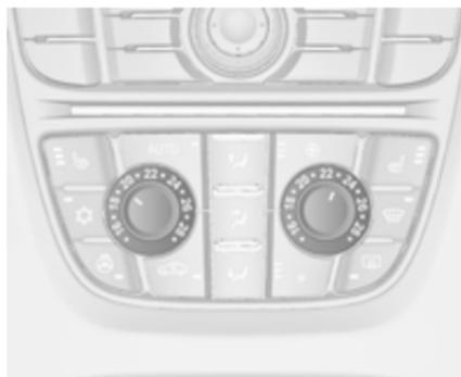
Se è impostata la temperatura minima **Lo**, il sistema di controllo del climatizzatore funziona al raffreddamento massimo, se
