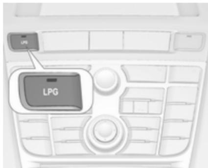
Premendo il pulsante **LPG** si passa dal funzionamento a benzina a quello a gas liquido e viceversa non appena i parametri necessari (temperatura del liquido refrigerante, temperatura del gas e regime minimo del motore) siano stati raggiunti. I requisiti vengono di solito soddisfatti dopo circa 60 secondi (in base alla temperatura esterna) e alla prima pressione decisa dell'acceleratore. Lo stato del LED mostra l'attuale modalità di funzionamento.
