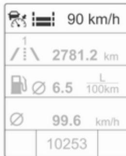
Il simbolo del cruise control adattivo, l'impostazione della distanza anteriore la velocità impostata sono indicati nella riga superiore del Driver Information Centre.
