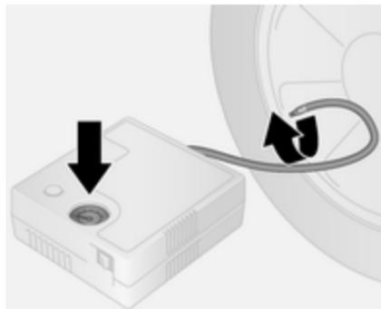
17. Mettersi immediatamente in marcia, in modo da distribuire uniformemente il sigillante nel pneumatico. Dopo aver percorso circa 10 km, non oltre 10 minuti di viaggio), fermarsi e controllare la pressione dei pneumatici con il compressore. Avvitare il flessibile dell'aria del compressore direttamente sulla valvola del pneumatici quando si effettua questa operazione.
