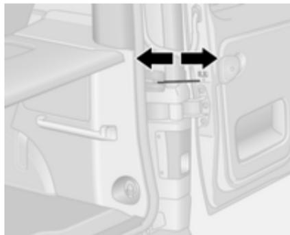
Durante la chiusura delle portiere, fissare i fermaporta alla rispettiva chiusura sul telaio della portiera.
