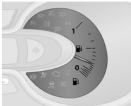
Visualizza il livello del carburante nel serbatoio.
