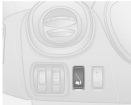
Se necessario, in caso di terreno molle, fango o neve su strada, è possibile disattivare il Sistema di controllo trazione (TC) per aumentare la trazione:
