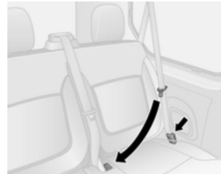
Prima di montare la cintura, inserire prima la piastra di chiusura inferiore nella fibbia di sinistra. Portare la piastra di chiusura superiore, con la cintura, sopra la zona addominale e la spalla (non attorcigliare) e innestarla nella fibbia destra.
