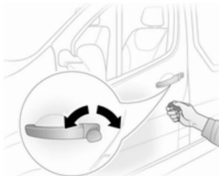
Bloccare o sbloccare manualmente le portiere ruotando la chiave nella serratura.
