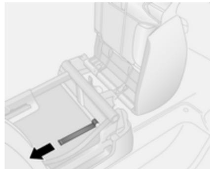
Per poter posizionare oggetti lunghi sotto i sedili posteriori (solo sul lato passeggero anteriore del veicolo), le falde del rivestimento inferiori possono essere sbloccate.
