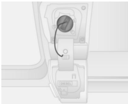
Per aprire il tappo del serbatoio del carburante, ruotarlo in senso antiorario.
