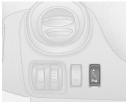
Disattivare il sistema premendo il tasto **P** sul quadro strumenti con il quadro acceso. Il LED si illumina nel
