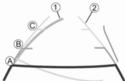
In base alle versioni, la corsia di traiettoria (1) del veicolo viene visualizzata in blu sul display informativo. Visualizza il percorso del veicolo in base all'angolo di sterzata.
