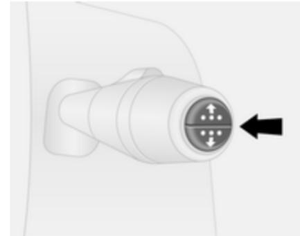
Con il veicolo fermo, premere il pulsante ripetutamente sull'estremità della leva del tergicristalli fino a quando non venga visualizzato il menù della pressione degli pneumatici.
