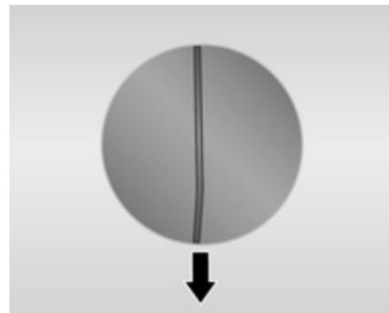
Se necessario, rimuovere prima la copertura all'interno del portellone posteriore, poi tirare la fascetta metallica verso il basso per sbloccare. Spingere il portellone posteriore per aprire.
