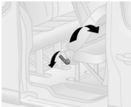
Per agevolare l'accesso ai sedili posteriori, tirare la leva di sbloccaggio e piegare lo schienale in avanti. Se necessario, staccare le cinture di sicurezza dalle relative fibbie.
