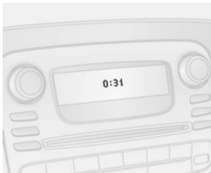
Le ore e i minuti possono essere regolati premendo i pulsanti appropriati del display o tramite i comandi del sistema Infotainment.
