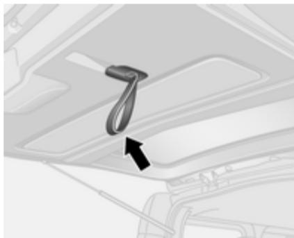
Chiudere il portellone posteriore utilizzando la cinghia interna. Verificare che il portellone sia completamente chiuso.
