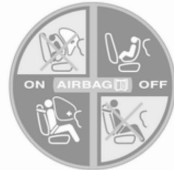
Il dispositivo di disattivazione degli airbag potrebbe essere segnalato da un'etichetta sul lato del cruscotto, visibile con la portiera del passeggero anteriore aperta.
