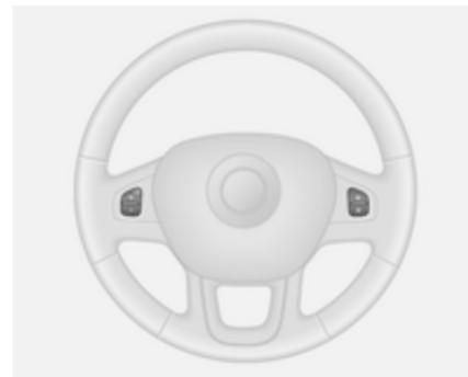
È possibile agire sul controllo della velocità di crociera e sul limitatore di velocità tramite i comandi sul pannello dello sterzo.
