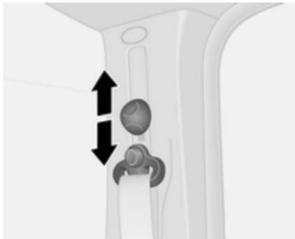
Abbassare o alzare il dispositivo di regolazione secondo necessità:
