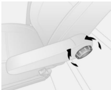
Ruotare la manopola per regolare il supporto lombare secondo necessità. La manopola consente di aumentare o diminuire il supporto lombare.
