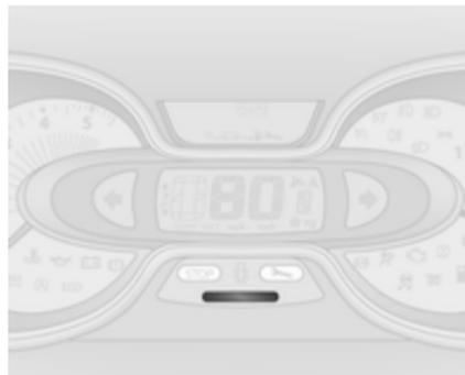
L'indicatore del risparmio carburante fornisce un calcolo istantaneo del consumo del carburante in base allo stile corrente di guida.
