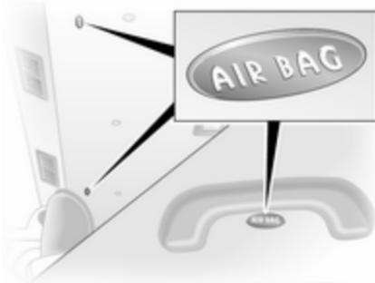
Il sistema airbag a tendina è composto da due airbag incorporati nel telaio del tetto, uno per lato. La loro pre-
