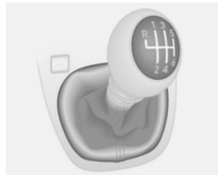
Retromarcia: con il veicolo fermo, attendere 3 secondi premendo il pedale della frizione, quindi sollevare il collare sulla leva del cambio e innestare la marcia.
