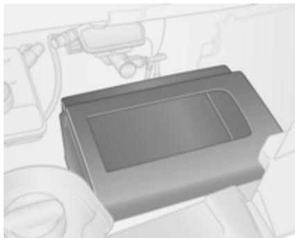
Smontare la copertura per accedere alla batteria.
