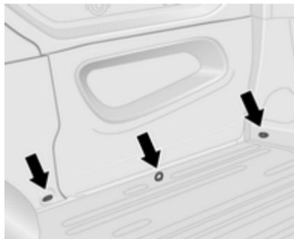
Il vano di carico è dotato di occhielli di ancoraggio per consentire il fissaggio del carico con cinghie o rete di contenimento, evitandone lo scivolamento.
