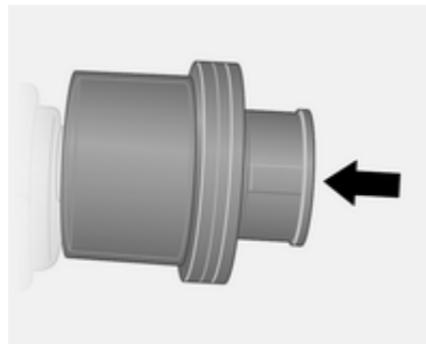
Alcuni modelli dispongono di un indicatore nel sistema di induzione del motore che indica una strozzatura dell'aspirazione dell'aria al motore.
