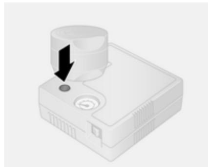
12. La pressione prescritta per il pneumatico si dovrebbe raggiungere entro 15 minuti. Pressione dei pneumatici  $\varnothing$  204. Quando si è raggiunta la pressione corretta, spegnere il compressore.
