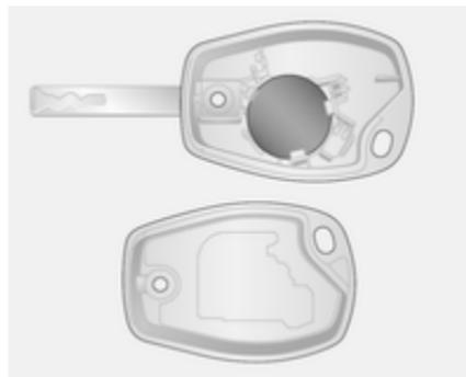
Sostituire la batteria (del tipo CR 2016) prestando attenzione alla posizione di montaggio.
