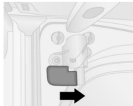
Per impedire alla portiera posteriore sinistra di essere aperta dall'esterno, inserire il bloccaggio di sicurezza antifurto dall'interno del veicolo.
