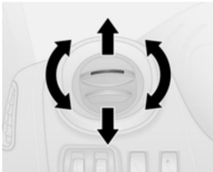
Per aprire o chiudere le bocchette di ventilazione laterali, inclinare le alette in alto o in basso.
