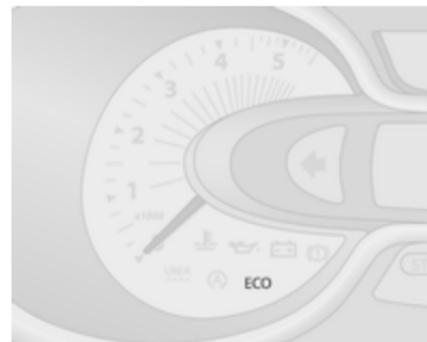
Durante la guida è possibile disabilitare temporaneamente la modalità ECO, ad es. per aumentare le prestazioni del motore, premendo con decisione il pedale dell'acceleratore. **ECO** lampeggia nel quadro strumenti.
