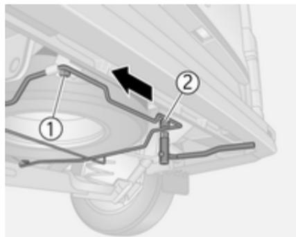
La ruota di scorta si trova sotto il sottoscocca posteriore ed è fissata con un bullone di sicurezza che può essere rimosso solo con la chiave a bussola in dotazione. Attrezzi per il veicolo ⇨ 166.
