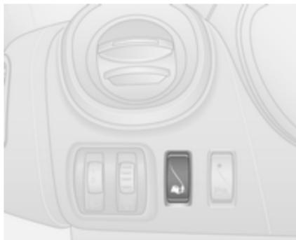
Se necessario, in caso di terreno molle, fango o neve su strada, è possibile disattivare il sistema ESP®Plus per potenziare la trazione:
