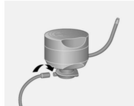
3. Avvitare il flessibile dell'aria al connettore del flacone di sigillante.
