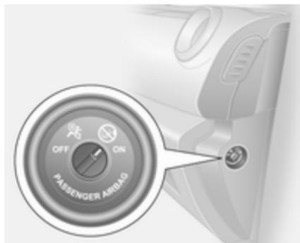
Per disattivare il sistema airbag del passeggero anteriore è necessario intervenire sull'interruttore ubicato sul lato del cruscotto. Aprire la portiera del passeggero anteriore per accedere all'interruttore.
