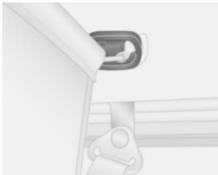
Staccare le coperture nel rivestimento del tetto (utilizzando un cacciavite a testa piatta) per accedere ai supporti, quindi inserire le aste della rete del vano di carico nei punti di montaggio di destra e di sinistra e fissarle.
