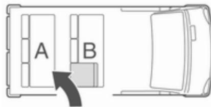
Quando si rimontano i sedili assicurarsi sempre che la fila con il sedile pieghevole di accesso **B** sia posizionata correttamente di fronte alla fila di sedili fissi **A**.
