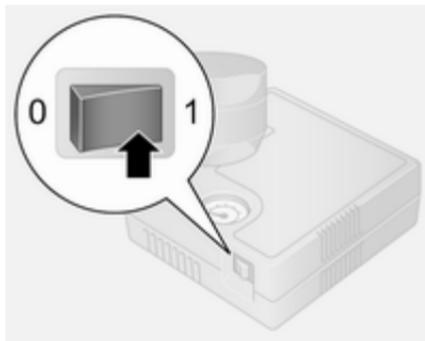
9. Premere l'interruttore del compressore su **I**. Il pneumatico viene riempito di sigillante.
