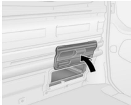
Ripiegare in alto la falda posteriore a mano; è mantenuta in posizione aperta da calamite.
