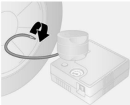
6. Avvitare il flessibile del sigillante sulla valvola del pneumatico.
