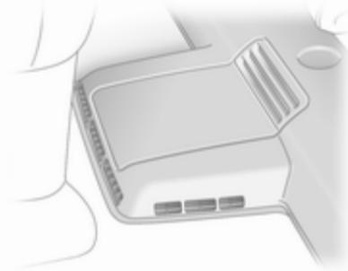
La ventola di riscaldamento posteriore fornisce aria alla zona posteriore dell'abitacolo tramite le bocchette posteriori.
