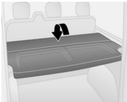
Il ripiano portapacchi posteriore può essere montato in 2 posizioni, cioè posizione superiore o posizione inferiore.
