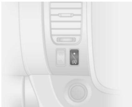
Disattivare manualmente il sistema stop-start premendo il tasto
