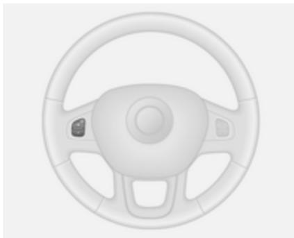
Accelerare fino alla velocità desiderata e premere l'interruttore **+** o **-**. La velocità attuale viene memorizzata e mantenuta; il pedale dell'acceleratore può essere rilasciato.
