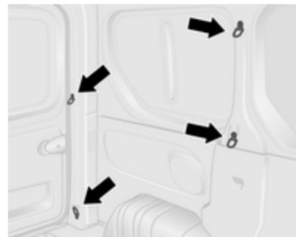
Occhielli di ancoraggio possono essere presenti sul pavimento del veicolo e/o nella parete laterale. Il numero e la posizione degli occhielli di ancoraggio può variare in base al veicolo.
