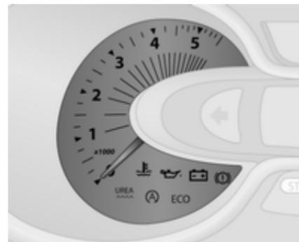
Indica la velocità di rotazione del motore.
