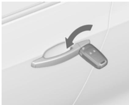
Sbloccare manualmente la portiera del conducente ruotando la chiave nella serratura. Inserire l'accensione e premere il pulsante di chiusura centralizzata
