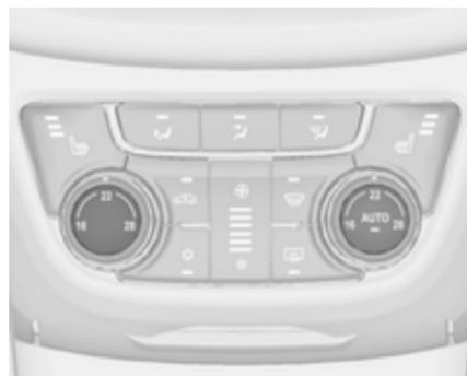
Se viene impostata la temperatura minima, il sistema di climatizzazione attiva il raffreddamento massimo.
