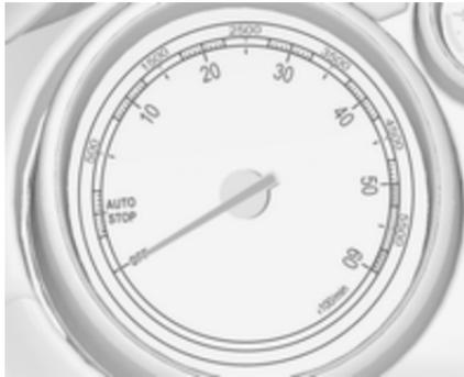
Indica la velocità di rotazione del motore.
