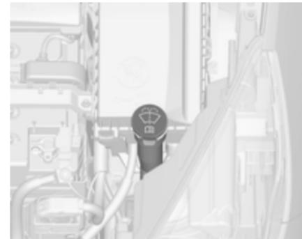
Riempire con acqua pulita miscelata con la giusta quantità di detergente per cristalli contenente antigelo. Per un rapporto di miscelazione corretto, controllare il contenitore del liquido di lavaggio.
