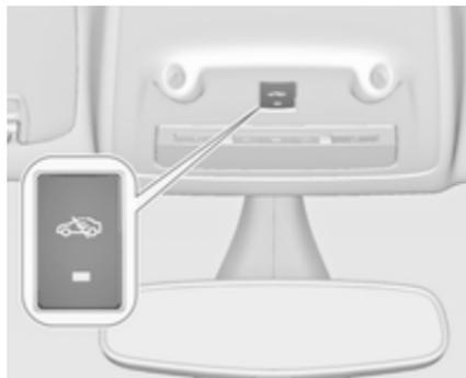
Disattivare la funzione di controllo dell'abitacolo e dell'inclinazione del veicolo se persone o animali sono all'interno del veicolo a causa dei forti segnali a ultrasuoni e della possibile
