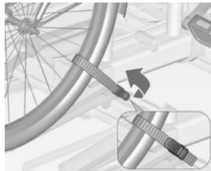
3. Assicurare le due ruote delle biciclette alle cavità della ruota utilizzando le apposite cinghiette di fissaggio.
