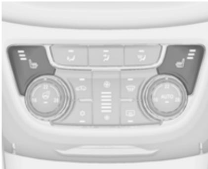
Regolare il riscaldamento sul livello desiderato premendo il pulsante
