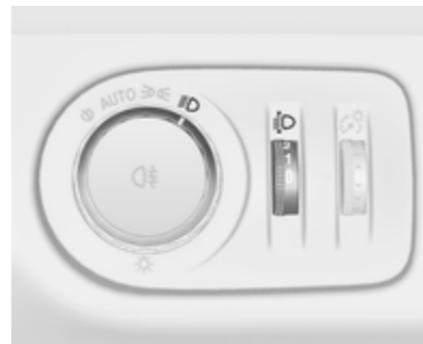
Per regolare la profondità delle luci in base al carico del veicolo e non abbagliare i conducenti dei veicoli in avvicinamento: ruotare l'interruttore rotante  $\text{D}$  nella posizione desiderata.
