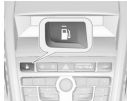
Premendo il pulsante
