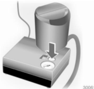
Se la pressione prescritta per il pneumatico non viene raggiunta entro 10 minuti, rimuovere il kit di riparazione dei pneumatici. Spostare il veicolo facendo compiere un giro al pneumatico. Ricollegare il kit di riparazione dei pneumatici
