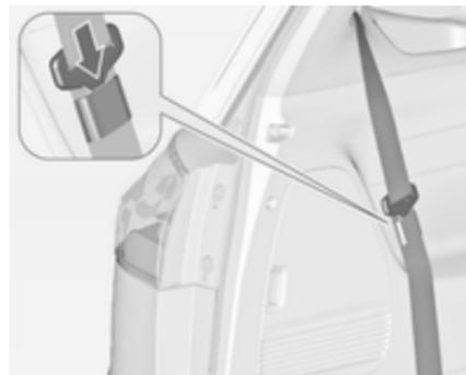
Prima di azionare la copertura del vano di carico, inserire la piastra di chiusura della cintura di sicurezza su ciascun lato nella tasca sulla cintura stessa.
