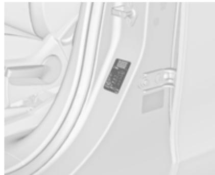
Pressione dei pneumatici ⇨ 276 e sull'etichetta sul telaio della portiera anteriore sinistra.
