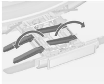
Ripiegare all'esterno entrambe le cavità delle ruote.
