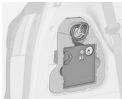
Il kit di riparazione dei pneumatici si trova sul lato sinistro nel vano di carico, dietro ad una copertura.
