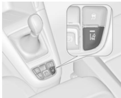
Attivare l'avvisatore di cambio accidentale della corsia di marcia premendo . Quando il sistema è inserito il LED del pulsante si accende. Quando la spia nel quadro strumenti si accende di colore verde, il sistema è pronto a entrare in funzione. Il sistema funziona solo a una velocità di marcia superiore a 60 km/h e in presenza di segnalazioni orizzontali di corsia.
