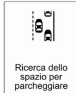
Se il veicolo passa accanto a una fila di veicoli con il sistema attivato, il dispositivo di assistenza al parcheggio avanzato cerca uno spazio di parcheggio adeguato. Al rilevamento di uno spazio adeguato, il sistema
