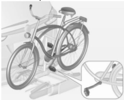
1. Ruotare i pedali in posizione come mostrato nell'illustrazione e mettere la bicicletta nella cavità più avanzata della ruota.
