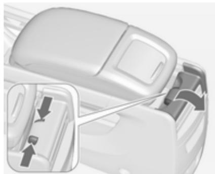
Premere i fermi verso l'interno e ripiegare il meccanismo di bloccaggio all'estremità posteriore del bracciolo.
