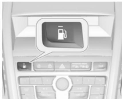
Premendo il pulsante
