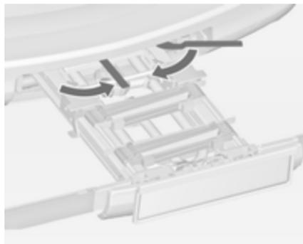
Portare le leve di bloccaggio all'interno il più possibile.
