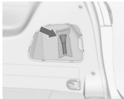
La canalina si trova sul lato destro del vano portaoggetti nel vano di carico.
