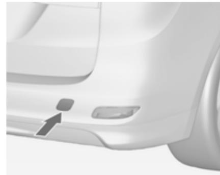
Inserire un cacciavite nella fessura sul bordo inferiore del cappello. Sganciare il coperchio muovendo con cautela il cacciavite verso il basso. Utilizzare un panno tra il cacciavite e il telaio per evitare eventuali danni.
