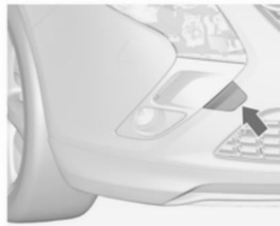
Inserire un cacciavite nella fessura sul bordo corto del cappello. Sgancciare il coperchio muovendo con cautela il cacciavite lateralmente. Utilizzare un panno tra il cacciavite e il telaio per evitare eventuali danni.
