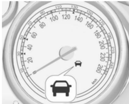
L'indicatore di veicolo davanti
