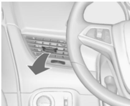
Per chiudere la bocchetta dell'aria, girare la manopola di regolazione in posizione **0**.
