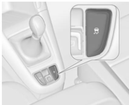
Il sistema di controllo della trazione può essere disattivato quando è richiesto lo slittamento delle ruote motrici: premere brevemente il pulsante
