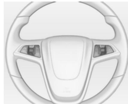
È possibile controllare il sistema Infotainment, alcuni sistemi di assistenza al conducente e il telefono cellulare collegato tramite i comandi al volante. Per maggiori informazioni consultare il manuale del sistema Infotainment.
