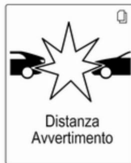
In caso di avvicinamento troppo repentino a un veicolo, il Driver Information Centre visualizza la pagina di avvertimento dell'allarme collisione. Allo stesso tempo il sistema emette una segnalazione acustica. Premere il pedale del freno se richiesto dalla situazione.
