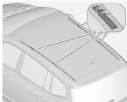
Per fissare un portapacchi, rimuovere i tappi nei listelli sul tetto. Inserire il materiale di montaggio, come indicato, nel fermo mostrato in figura.
