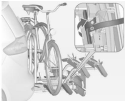
4. Far passare la cinghietta attaccata all'adattatore sotto alla leva per ripiegare all'indietro il sistema di trasporto posteriore. Fissare la cinghietta.
