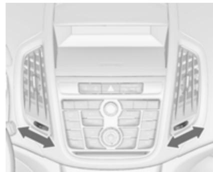
Per aprire la bocchetta dell'aria, ruotare la rotella su **I**. Regolare la quantità di aria all'uscita della bocchetta ruotando la manopola di regolazione.
