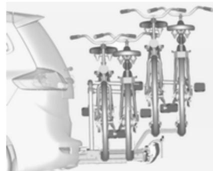
Il sistema di trasporto posteriore (Flex-Fix system) consente di trasportare due biciclette su un portabiciclette estraibile integrato nel pavimento della vettura. È possibile caricare altre due biciclette utilizzando un adattatore. Non è permesso trasportare altri oggetti.
