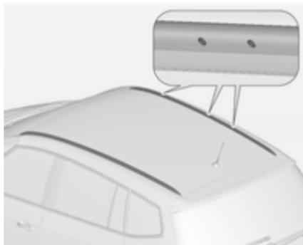
Per fissare un portapacchi, inserire i bulloni di montaggio nei fori indicati nell'illustrazione.
