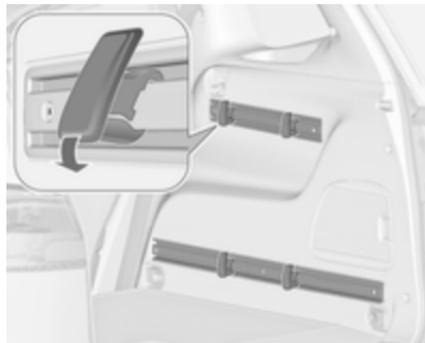
Installare i ganci nelle posizioni desiderate sulle guide: inserire il gancio nella scanalatura superiore della guida e premere per fissarlo nella scanalatura inferiore.
