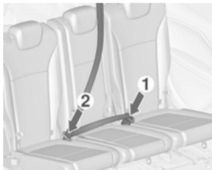
Rimuovere la piastra di chiusura inferiore dal fermo e innestarla nella fibbia sinistra (1) del sedile centrale. Portare la piastra di chiusura superiore, con la cintura, sopra la zona addominale e la spalla (non attorcigliare) e innestarla nella fibbia destra (2) del sedile centrale.
