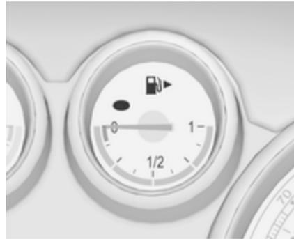
Indica il livello del carburante o la pressione del gas nel serbatoio, a seconda della modalità di funzionamento.
