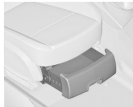
Premere il pulsante nell'incavo ed estrarre il cassetto. Carico massimo: 3 kg. Spingere il vano e innestarlo per chiuderlo.
