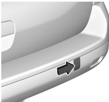
Sul paraurti posteriore, premere la piastra di copertura sul suo angolo di sinistra superiore per sganciarla.
