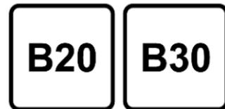
È consentito l'utilizzo di carburante B20 o B30 conforme alla norma EN16709. Tuttavia, se si utilizza
