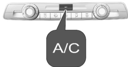
Premere **A/C** per inserire il raffreddamento. Il LED del pulsante si illumina per indicare l'attivazione. Il raffreddamento funziona solamente con il motore acceso e la ventola inserita.
