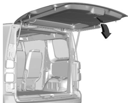
Per abbassare il portellone utilizzare la maniglia interna. Spingere il portellone da sopra fino a quando non sia completamente chiuso.
