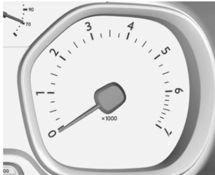
Indica la velocità di rotazione del motore.
