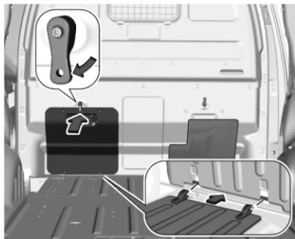
Girare il dispositivo di bloccaggio verso l'alto. Inserire le linguette dello sportello nel rispettivo alloggiamento, sollevarlo e chiudere il dispositivo di bloccaggio.
