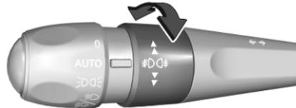
Ruotare la rotellina di comando una volta per attivare o disattivare i fendinebbia anteriori.
