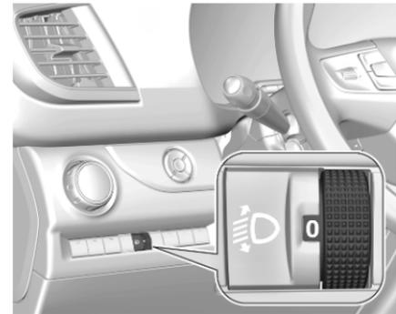
Per regolare la profondità delle luci in base al carico del veicolo e non abbagliare i conducenti dei veicoli in avvicinamento: ruotare l'interruttore rotante
