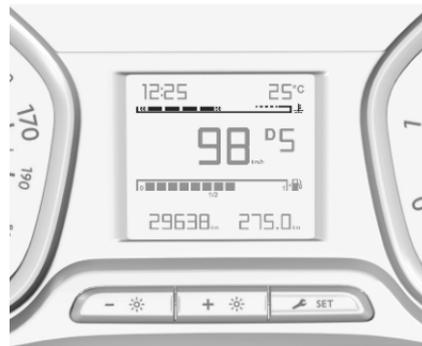
Una scala costituita da segmenti bianchi indica la temperatura del refrigerante motore.
