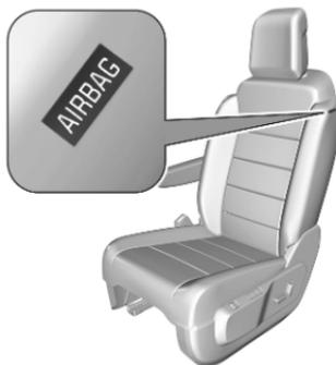
Il sistema airbag laterale è formato da due airbag, uno su ciascun bracciolo del sedile anteriore. La loro presenza viene segnalata dalla scritta **AIRBAG**.
