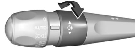
Ruotare la rotellina di comando una volta per attivare o disattivare i retronebbia.
