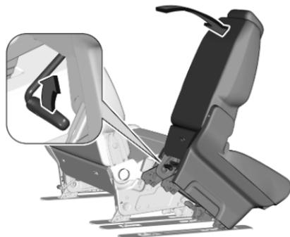
Tirare la leva di sblocco e inclinare il sedile in avanti.
