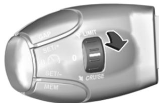
Ruotare su **Cruise**, il simbolo
