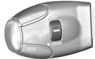
Ruotare su **0** per disattivare il sistema. Il simbolo  $\nearrow \searrow$  e un messaggio vengono visualizzati nel Driver Information Center.
