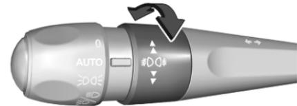
Ruotare la rotellina di comando due volte per attivare o disattivare i retro-nebbia.
