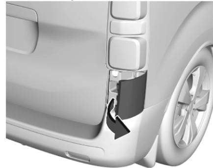
1. Veicoli con copertura che nasconde la vite del gruppo ottico posteriore basso: rimuovere con cautela la copertura sbloccando le linguette di fermo con un cacciavite e inclinando leggermente la copertura verso l'esterno.
