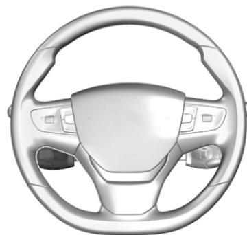
Controllo automatico della velocità di crociera, Cruise control semi-adattivo e limitatore di velocità vengono azionati attraverso il controllo assistenza al conducente sul lato sinistro del piantone dello sterzo.
