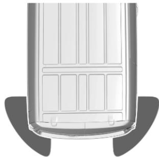
La chiave elettronica deve trovarsi all'esterno del veicolo, in un raggio d'azione di ca 1 m dai sensori di movimento. In base alla configurazione del veicolo, la chiave elettronica deve essere posizionata nella rispettiva area. Non mantenere il piede in tale posizione troppo a lungo o non muoverlo troppo lentamente sotto il paraurti.
