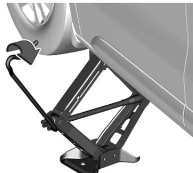
Con il martinetto correttamente allineato, ruotare la chiave fino a quando la ruota non poggia più per terra.
