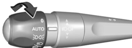
Quando la funzione di comando automatico dei fari è attivata e il motore è in funzione, il sistema passa dalle luci diurne all'accensione dei fari automaticamente, a seconda delle condizioni della luminosità esterna e delle informazioni fornite dal sistema dei tergi-cristalli.
