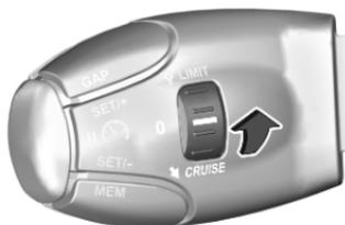
Ruotare su **Limit**, il simbolo
