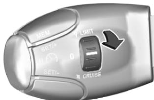
Ruotare su **CRUISE**, il simbolo
