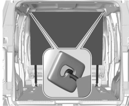
1. Sono presenti aperture di montaggio su entrambi i lati del telaio del tetto. Se presente, aprire le coperture.
