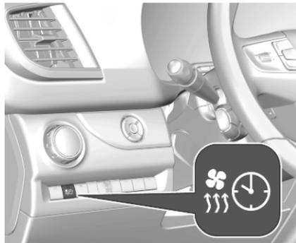
Lo stato operativo del riscaldatore da parcheggio è indicato da un indicatore dotato di un LED.
