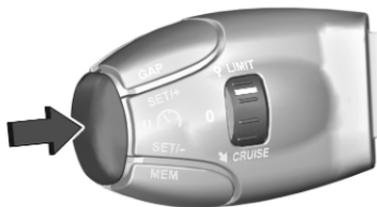
Premere il pulsante per azionare il sistema con l'ultima velocità programmata.
