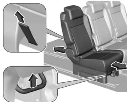
Per rilasciare il sedile, tirare la maniglia anteriore in alto o tirare l'anello sul retro senza oltrepassare il punto di resistenza.
