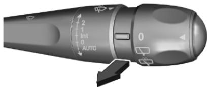
Il liquido di lavaggio viene spruzzato sul parabrezza e il tergicristalli effettua alcuni passaggi.
