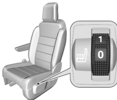
La rotella del riscaldamento sedile può essere posizionata sul sedile o sul quadro strumenti.
