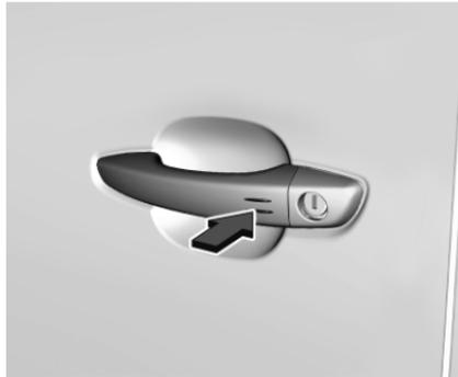
**Sistema chiave elettronica:** Se si sblocca il veicolo premendo gli appositi segni sulle maniglie delle portiere anteriori, l'impianto di allarme antifurto viene disattivato.
