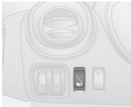
Se necessario, in caso di terreno molle, fango o neve su strada, è possibile disattivare il sistema ESC per potenziare la trazione:
