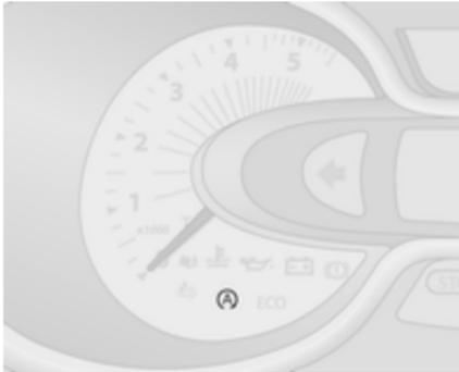
Ⓐ si accende in nel quadro strumenti per segnalare un Autostop ⇨ 105.
