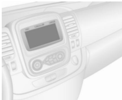
Nei veicoli con sistema di navigazione, il display della videocamera posteriore potrebbe essere mostrato sul Visualizzatore Info (a seconda della versione).
