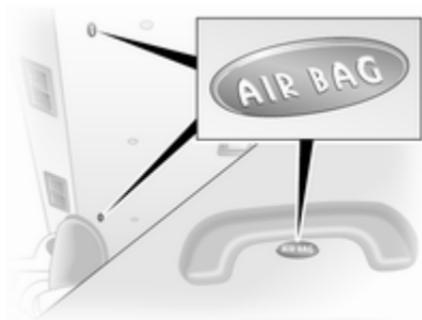
Il sistema airbag a tendina è composto da due airbag incorporati nel telaio del tetto, uno per lato. La loro
