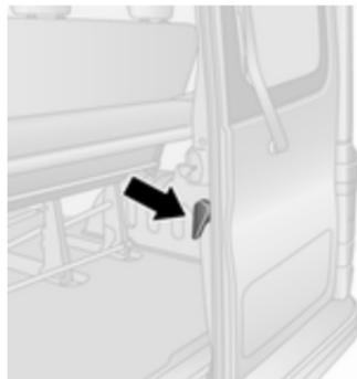
Per aprire la porta posteriore destra è necessario sbloccarla tramite la leva.
