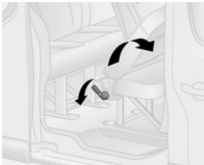
Per agevolare l'accesso ai sedili della 3<sup>a</sup> fila (ove siano presenti), aprire la portiera laterale scorrevole e abbassare la leva di sblocco del sedile ribaltabile di accesso della 2<sup>a</sup> fila e piegare lo schienale del sedile in avanti. Se necessario, slacciare le cinture di sicurezza dalle relative fibbie.
