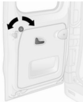
Girare l'interruttore di bloccaggio in senso orario per bloccare la portiera posteriore sinistra dall'interno del
