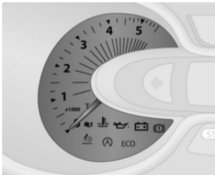
Indica la velocità di rotazione del motore.
