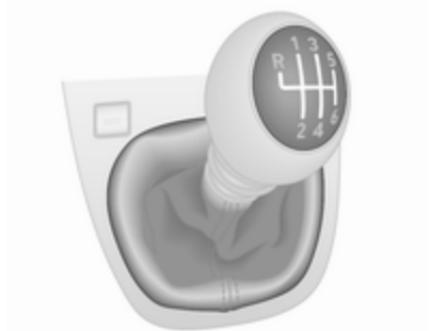
Per inserire la retromarcia, premere il pedale della frizione a veicolo fermo, sollevare il collare sulla leva del cambio e inserire la marcia in senso contrario alla resistenza.
