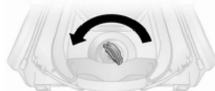
Far scorrere il sedile in avanti e ripiegare lo schienale in avanti ⇨ 49 per accedere alla scatola degli attrezzi. La scatola degli attrezzi può essere fissata in posizione con un galletto. Ruotare il dado a galletto in senso antiorario per sbloccarlo.
