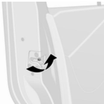
Per impedire alle portiere anteriori di essere aperte dall'esterno, aprire la portiera del conducente e inserire il blocco di sicurezza antifurto.
