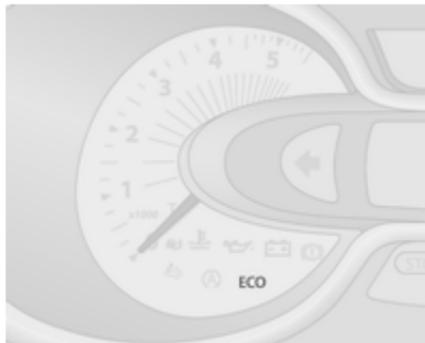
Durante la guida è possibile disabilitare temporaneamente la modalità ECO, ad es. per aumentare le prestazioni del motore, premendo con decisione il pedale dell'acceleratore.
