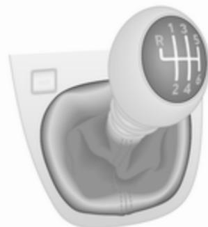
Retromarcia: con il veicolo fermo, attendere tre secondi premendo il pedale della frizione, quindi sollevare il collare sulla leva del cambio e innestare la marcia.
