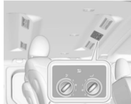
La ventola di climatizzazione posteriore fornisce aria alla zona posteriore dell'abitacolo tramite le bocchette posteriori. La quantità di aria immessa è determinata dalla ventola.
