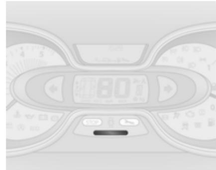
A seconda della versione, l'indicatore del risparmio carburante (o "spia dello stile di guida") fornisce il calcolo istantaneo dell'efficienza del carburante, in base allo stile di guida corrente).
