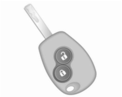
A seconda del modello e della configurazione, premere
