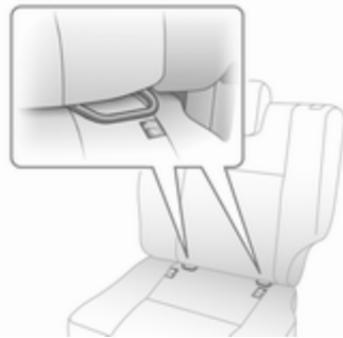
Fissare i sistemi di sicurezza per bambini ISOFIX omologati per il veicolo in questione ISOFIX alle staffe di montaggio.
