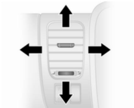
Per aprire o chiudere le bocchette dell'aria centrali e indirizzare il flusso d'aria, inclinare le alette in alto o in basso e ruotare la rotella di regolazione a sinistra o a destra.
