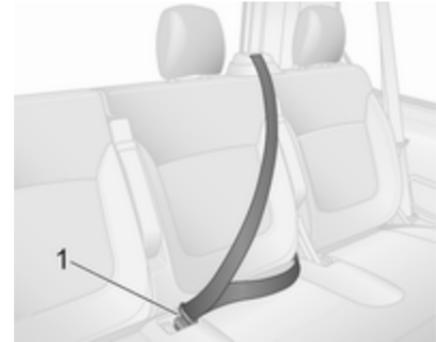
Per il sedile posteriore centrale, inserire la piastra di chiusura nella fibbia 1.
