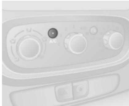
Premere **A/C** per inserire il raffreddamento. L'attivazione è indicata dall'illuminazione del LED sul pulsante. Il raffreddamento funziona solamente con il motore acceso e la ventola di controllo del climatizzatore inserita.
