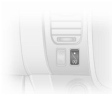
Disattivare manualmente il sistema stop-start premendo
