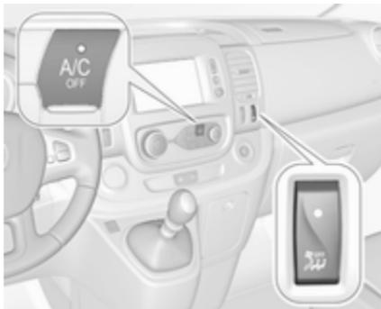
Per attivare la ventola del riscaldamento premere
