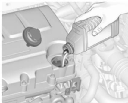
Consigliamo di utilizzare lo stesso grado di olio motore che è stato rifornito nell'ultima sostituzione.
