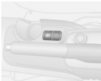
Disattivare il sistema stop-start manualmente premendo il pulsante
