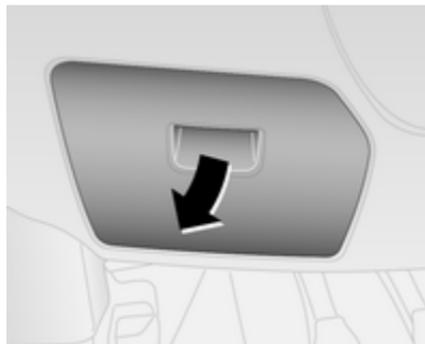
La scatola portafusibili si trova dietro ad una copertura sulla parte inferiore del quadro strumenti, sul lato del conducente.
