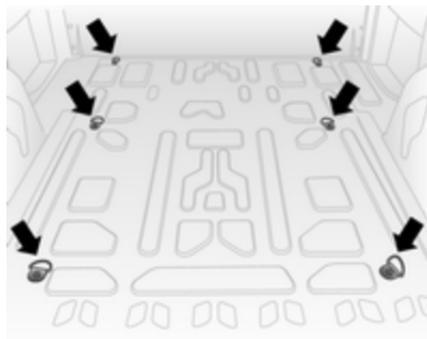
Gli occhielli di ancoraggio servono per fissare gli oggetti ed evitare che scivolino, ad es. utilizzando delle cinghie di ancoraggio o una rete fermabagagli.
