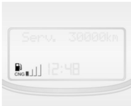
Nella modalità di funzionamento a gas metano, le quattro barre verticali accanto a **CNG** corrispondono al livello di metano nei cilindri. Col diminuire del livello del carburante, le barre nell'indicatore del carburante GNC scompaiono.
