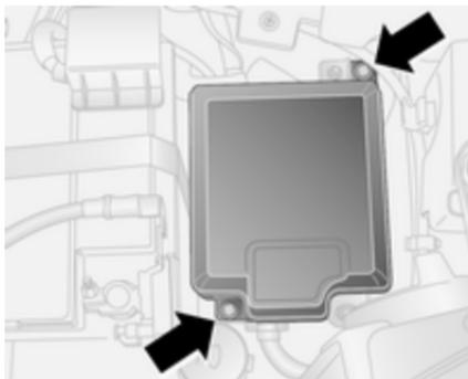
La scatola portafusibili si trova a destra del vano motore, accanto alla batteria.
