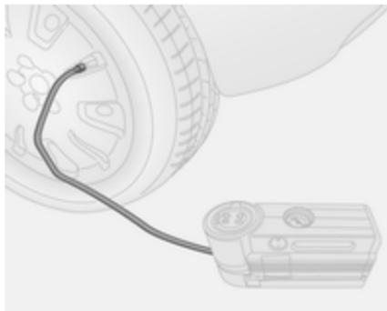
5. Avvitare il flessibile sulla valvola del pneumatico.
