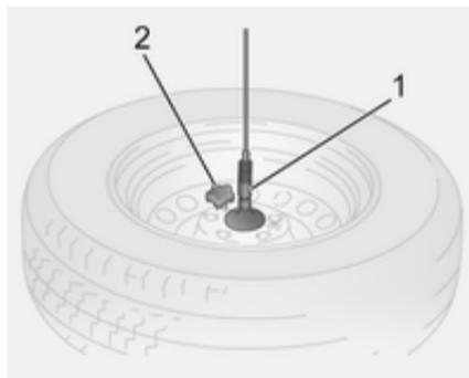
8. Far passare il fermo 1 attraverso il foro nel cerchio, inserendo il perno di riferimento in uno dei fori della vite e fissare con la manopola 2.
