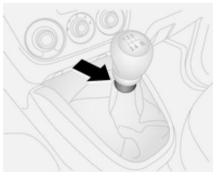
Per inserire la retromarcia: con il veicolo fermo, attendere 3 secondi premendo il pedale della frizione, sollevare il collare sulla leva del cambio e innestare la marcia.
