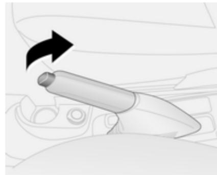
Azionare sempre energicamente il freno di stazionamento senza premere il pulsante di sblocco, e tirarlo con la maggior forza possibile nei tratti in salita o in discesa.
