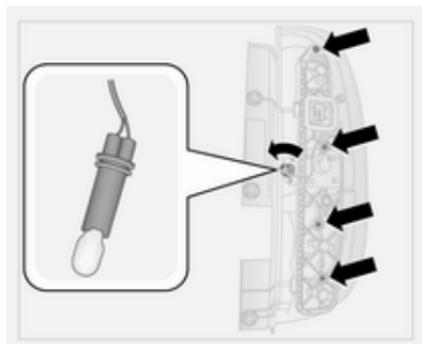
4. Svitare le quattro viti di fermo utilizzando un cacciavite. Ruotare il portalampada della luce della retromarcia in senso antiorario e sostituire la lampadina.
