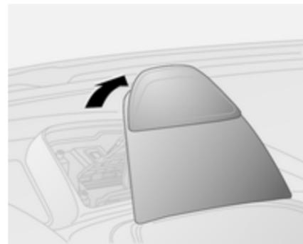
Tirare la parte posteriore del portadocumenti verso l'alto dal quadro strumenti e lasciarlo in posizione inclinata.
