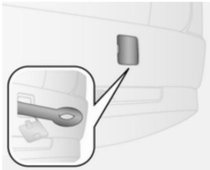
Inserire un cacciavite nella fessura sul lato del cappello. SganCIARE il coperchio facendo delicatamente leva con un cacciavite. Utilizzare un panno tra il cacciavite e il telaio per evitare eventuali danni.
