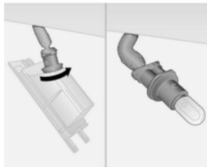
2. Ruotare il portalampadina in senso antiorario per smontarlo dall'alloggiamento della lampadina. Estrarre la lampadina e rimuoverla.
