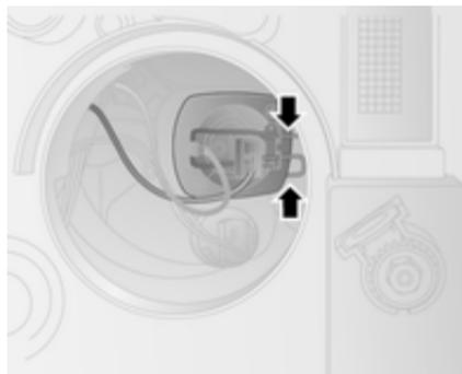
4. Inserire una nuova lampadina nel riflettore in modo che la lampadina sia allineata con la cavità del riflettore.
