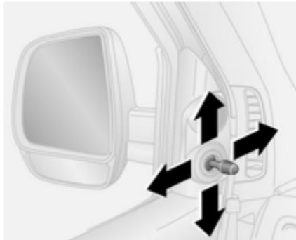
Regolare gli specchietti ruotando la leva nella direzione necessaria.
