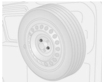
1. Svitare due viti utilizzando la chiave e rimuovere la ruota di scorta dalla staffa. Attrezzi per il veicolo ⇨ 146.
