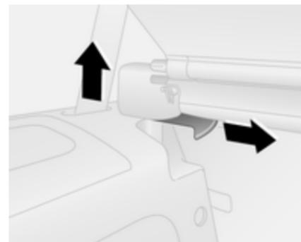
Aprire la copertura del vano di carico. Tirare la leva di rilascio e sollevare la copertura dai fermi.
