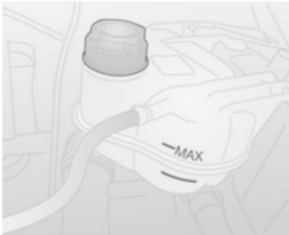
Quando il sistema di raffreddamento è freddo, il livello del liquido di raffreddamento deve essere compreso tra i segni **MIN** e **MAX**. Rabboccare se il livello è basso.
