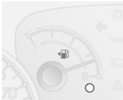
Indica il livello del carburante o il livello di gas nel serbatoio, a seconda della modalità di funzionamento.
