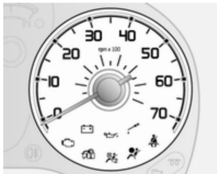
Indica la velocità di rotazione del motore.
