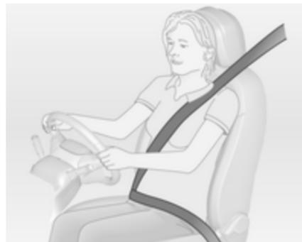
Regolare l'altezza della cintura in modo che questa poggi sulla spalla, e non sul collo o sul braccio.
