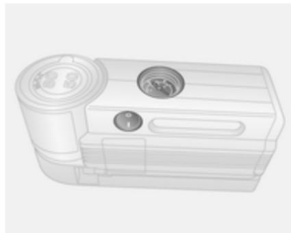
8. Portare l'interruttore basculante sul compressore in posizione **I**. Il pneumatico viene riempito di sigillante.
