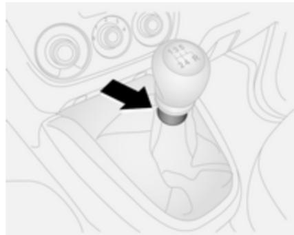
Retromarcia: con il veicolo fermo, attendere 3 secondi premendo il pedale della frizione, sollevare il collare sulla leva del cambio e innestare la marcia.
