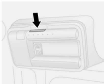
In base alla variante di modello, la luce di cortesia posteriore rimovibile potrebbe illuminarsi quando le portiere posteriori / portellone posteriore o le portiere laterali scorrevoli vengono aperte e l'interruttore centrale si trova in posizione centrale.
