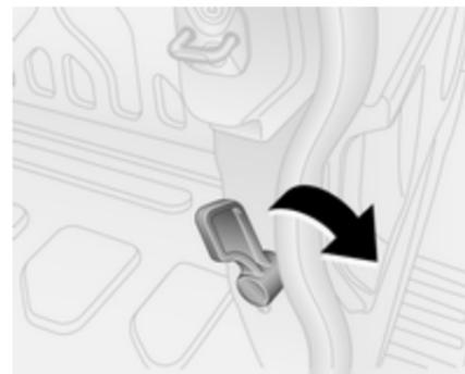
Per aprire la porta posteriore destra è necessario sbloccarla tramite la leva.
