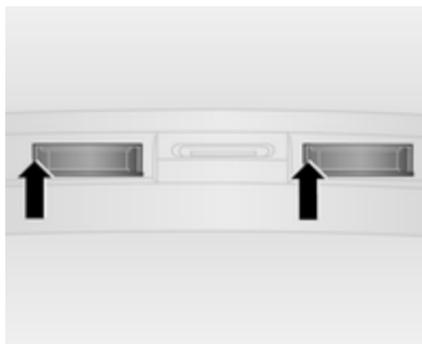
1. Inserire il cacciavite come indicato dalle frecce, premere di lato e sbloccare l'alloggiamento della lampadina.
