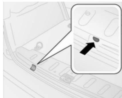
2. Inserire la chiave nell'apertura del pavimento del vano di carico.
