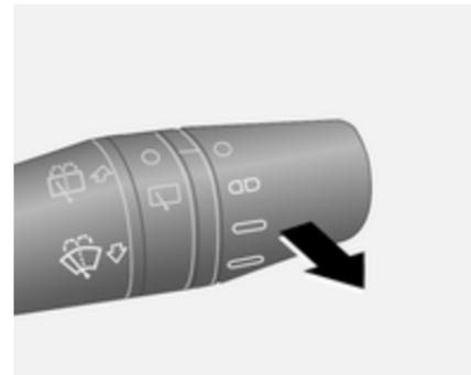
Tirare brevemente la leva: il liquido di lavaggio viene spruzzato sul parabrezza e il tergilavacrystalli effettua alcuni passaggi.
