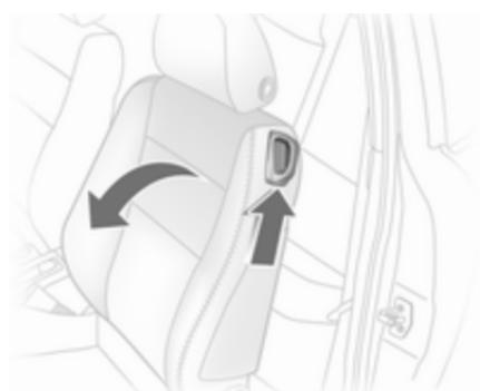
Solleverla la leva di sblocco e piegare lo schienale in avanti. Abbassare la leva di sblocco: lo schienale si blocca nella posizione abbassata. Far scorrere il sedile in avanti.
