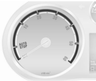
Indica la velocità di rotazione del motore.
