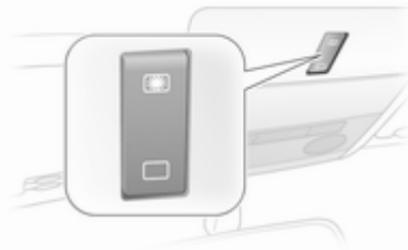
Funzionamento mediante interruttore a bilanciere nella consolle del tetto.
