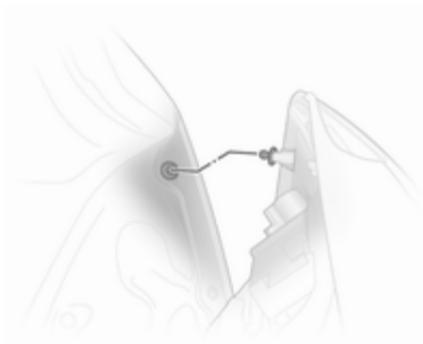
9. Inserire l'alloggiamento nella carrozzeria, serrando i dadi di sicurezza manualmente. Inserire il connettore. Chiudere la copertura.
