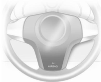
Il sistema airbag anteriore è composto da un airbag nel volante e un airbag nel quadro strumenti sul lato passeggero anteriore. La loro presenza viene segnalata dalla scritta **AIRBAG**.
