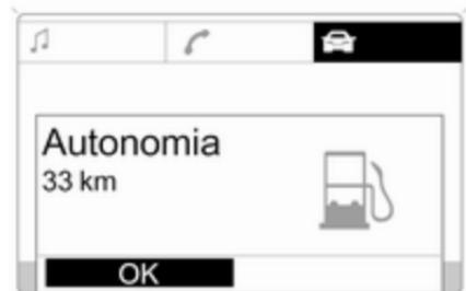
Quando il livello di carburante nel serbatoio è basso, il display visualizza il messaggio **Autonomia**.
