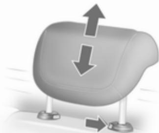
È possibile regolare l'altezza del poggiatesta in due posizioni. Per eseguire la regolazione nella prima posizione, tirare il poggiatesta verso l'alto. Per la seconda posizione, premere la molla indicata nell'illustrazione e portare il poggiatesta verso l'alto il più possibile. Per eseguire la regolazione verso il basso, premere la molla indicata nell'illustrazione e spingere il poggiatesta verso il basso.
