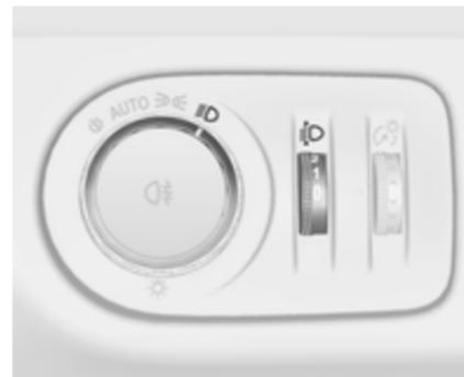
Per adattare la profondità delle luci al carico del veicolo ed evitare l'abbagliamento: ruotare la rotella  $\text{D}$  fino a visualizzare l'impostazione richiesta sul display dei chilometri. La visualizzazione rimane per 4 secondi, quando gli anabbaglianti sono accesi oppure ogni volta che si cambia profondità di illuminazione, assieme al simbolo  $\text{D}$ .
