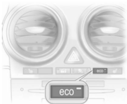
Disattivare il sistema Start-stop manualmente premendo il pulsante **eco**. La disattivazione è indicata dallo spegnimento del LED presente nel pulsante.
