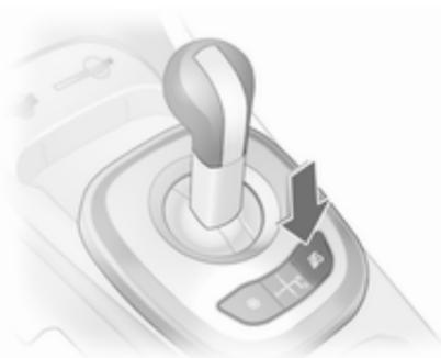
I tempi del cambio sono ridotti quando è abilitata la modalità Sport e le marce si inseriscono a velocità superiori del motore, ma non quando il regolatore di velocità è attivato.
