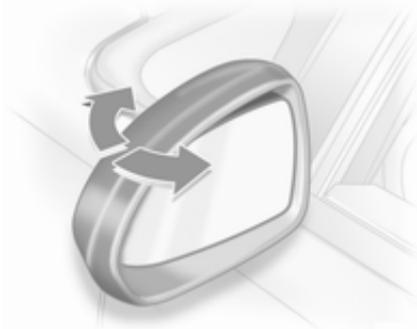
Per la sicurezza dei pedoni, i retrovisori esterni fuoriescono dalla normale posizione di montaggio se vengono colpiti con forza sufficiente. Per riposizionare lo specchietto è sufficiente esercitare una leggera pressione sul corpo dello stesso.
