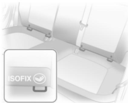
Fissare i sistemi di sicurezza ISOFIX per bambini, omologati per il veicolo in questione, alle staffe di montaggio.
