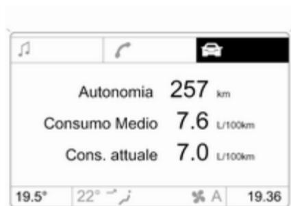
L'autonomia viene calcolata in base al livello corrente di carburante nel serbatoio e al consumo corrente. Il display visualizza valori medi.
