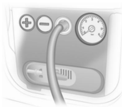
8. Premere il pulsante **+** del compressore. Il pneumatico viene riempito di sigillante.
