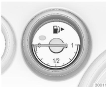
Visualizza il livello del carburante nel serbatoio.
