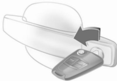
Ruotare del tutto la chiave nella serratura della portiera del conducente. All'apertura della portiera del conducente viene sbloccato l'intero veicolo. Per sbloccare le altre portiere, inserire l'accensione e premere il pulsante della chiusura centralizzata.
