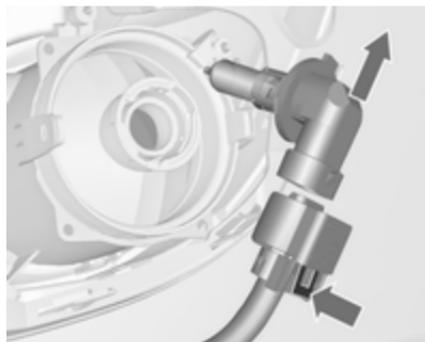
2. Sganciare il portalampada del connettore premendo sulla linguetta di fissaggio.
