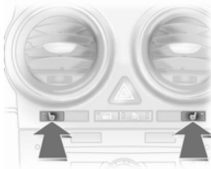
Attivare il riscaldamento premendo il pulsante del sedile con l'accensione inserita.
