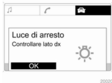
Il guasto delle luci viene indicato nel display informativo oppure nel display del quadro strumenti viene visualizzato il messaggio **InSP2**.
