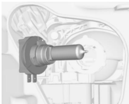
3. Inserire una nuova lampadina nel riflettore in modo che la linguetta di riferimento del portalampada sia allineato con la cavità del riflettore.
