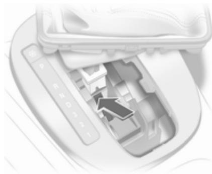
3. Portare il fermo giallo in avanti con un cacciavite e spostare la leva selettoria dalla posizione **P**. Se **P** è ancora inserita, la leva selettoria si bloccherà di nuovo in posizione. Rivolgersi ad un'officina per eliminare la causa dell'interruzione dell'alimentazione elettrica.
