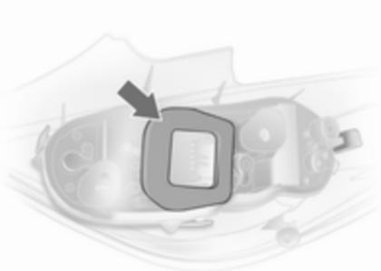
8. Assicurarsi che la guarnizione del portalampada sia posizionata come indicato in figura. Montare la guarnizione rotonda sul bullone di fissaggio.
