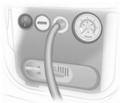
8. Premere l'interruttore di accensione/spegnimento sul compressore. Il pneumatico viene riempito di sigillante.
