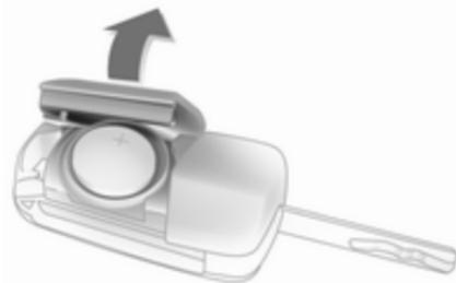
Estendere la chiave e aprire l'unità. Sostituire la batteria (di tipo CR 2032) prestando attenzione alla posizione di installazione. Chiudere l'unità e sincronizzarla.
