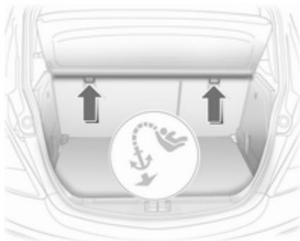
Fissare i sistemi di sicurezza Top Tether per bambini agli appositi occhielli che si trovano dietro al sedile posteriore e alla guida del sedile del passeggero nel vano piedi posteriore. La cinghia di aggancio deve passare tra le due aste di guida del poggiatesta.
