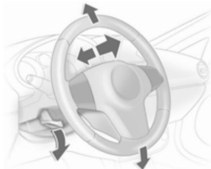
Sbloccare la leva, regolare la posizione del volante, quindi riportare la leva in posizione iniziale e accertarsi che sia completamente bloccata. Effettuare la regolazione del volante solo a veicolo fermo e bloccasterzo disinserito.
