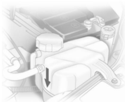
Quando il sistema di raffreddamento è freddo, il livello del liquido di raffreddamento dovrebbe essere al di sopra del segno **KALT/COLD**. Rabboccare se il livello è basso.
