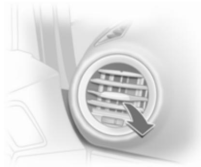
Per chiudere la bocchetta, ruotare la rotella di regolazione verso sinistra o verso destra fino a fine corsa.
