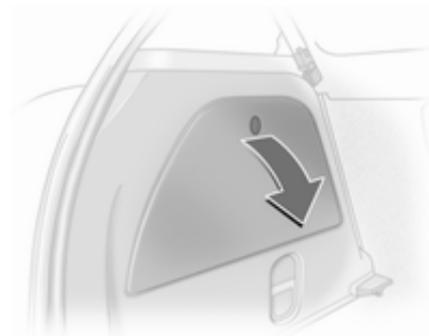
La scatola portafusibili si trova sul lato sinistro del vano bagagli, dietro ad una copertura. Rimuovere la copertura.
