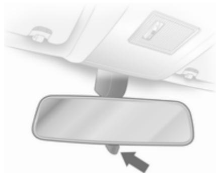
Per ridurre l'abbagliamento, regolare la leva nella parte inferiore del corpo dello specchietto.
