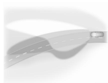
I fasci di luce vengono ruotati automaticamente in funzione della posizione del volante e della velocità del veicolo.
