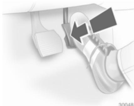
Premendo il pedale dell'acceleratore oltre il punto di resistenza, a seconda del regime del motore il cambio passa a una marcia inferiore.
