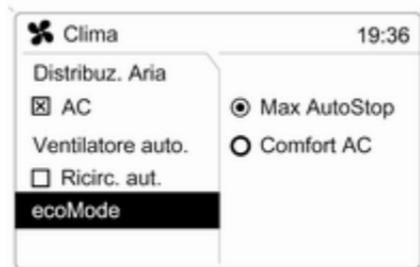
Nei veicoli dotati di sistema Start-stop, sono disponibili due impostazioni per il funzionamento del climatizzatore durante un Autostop.
