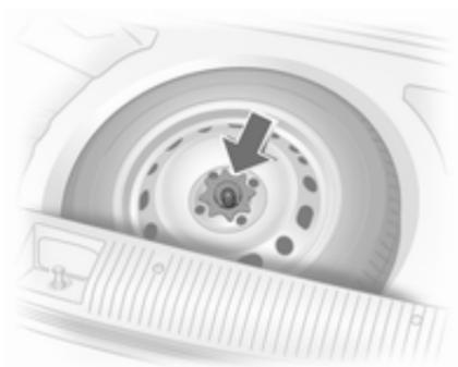
La ruota di scorta è situata nel vano di carico sotto la copertura del pianale. È fissata mediante un dado ad alette.
