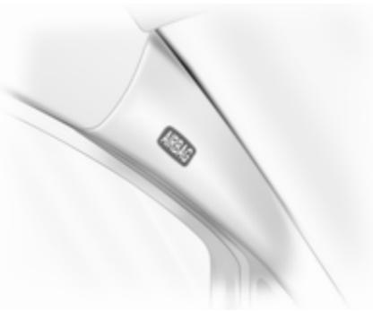
Il sistema airbag a tendina è composto da due airbag incorporati nel telaio del tetto, uno per lato. La loro presenza viene segnalata dalla scritta **AIRBAG** sui montanti del tetto.
