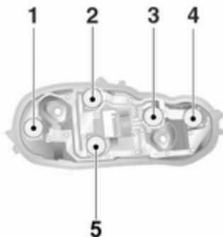
6. Spingere leggermente la lampadina nel portalampada, ruotarla in senso antiorario, rimuoverla e sostituirla.
