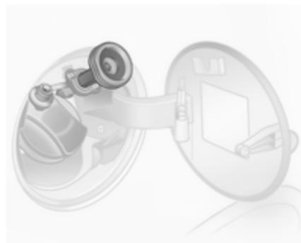
**Adattatore ACME:** Avvitare il dado dell'ugello di riempimento sull'adattatore. Premere in basso la leva di bloccaggio sull'ugello di riempimento.
