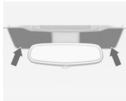
Le aree segnate sul parabrezza dietro lo specchietto retrovisore non sono coperte con il rivestimento. I dispositivi per la registrazione elettronica dei dati e il pagamento dei
