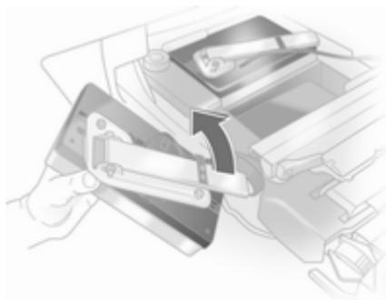
Aprire il supporto della lampada sulla parte posteriore delle luci posteriori fino a quando si blocca in posizione.
