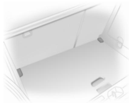
Se montato nella posizione superiore, lo spazio tra il pianale del vano di carico e la copertura della ruota di scorta può essere utilizzato come vano di stivaggio.
