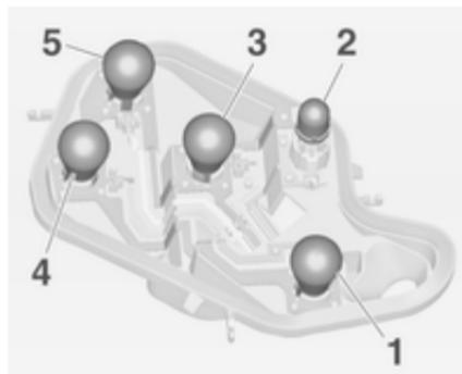
6. Spingere leggermente la lampadina nel portalampada, ruotarla in senso antiorario, rimuoverla e sostituirla.
