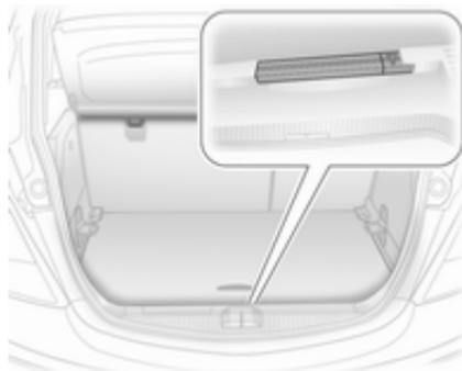
Riporre il triangolo di segnalazione nella parete del vano di carico posteriore: prima posizionare il triangolo di segnalazione nella sagomatura a sinistra e poi inserirlo nella guida a destra.
