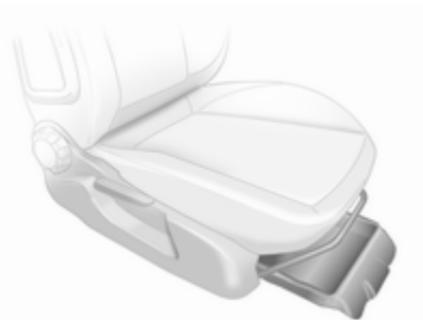
Sollevare in corrispondenza del bordo rientrante ed estrarre. Carico massimo: 1,5 kg. Per chiudere il vano, spingerlo indietro e bloccarlo in posizione
