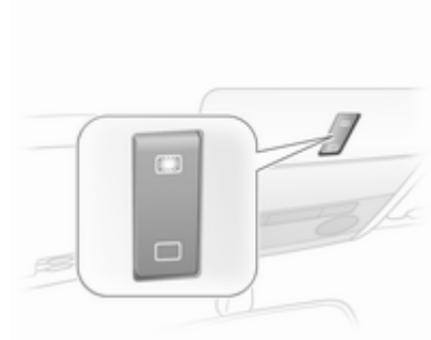
Funzionamento mediante interruttore a bilanciere nella consolle del tetto.
