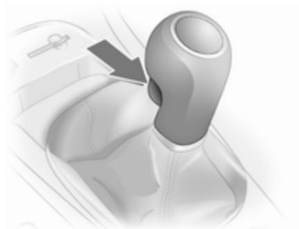
Per innestare la retromarcia con il veicolo fermo, attendere 3 secondi dopo aver premuto il pedale della frizione, quindi premere il pulsante di sblocco sulla leva del cambio e inserire la marcia.
