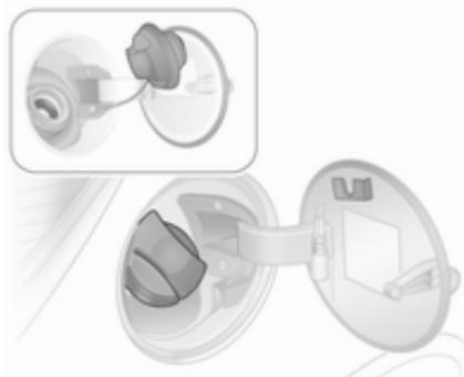
Sbloccare il tappo del serbatoio del carburante con la chiave di accensione, svtarlo e rimuoverlo. Il tappo del serbatoio del carburante può essere posato sull'apposita staffa presente sullo sportellino del carburante.
