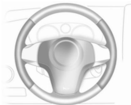
Il volante è riscaldato nelle aree indicate nell'illustrazione quando il motore è acceso e durante un Autostop.
