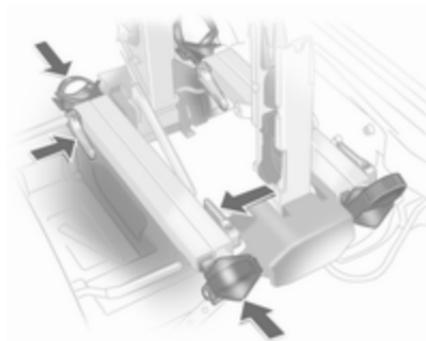
Premere la leva di sblocco e far scivolare le cavità della ruota il più possibile.
