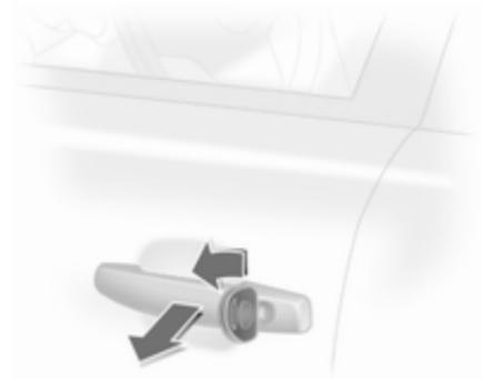
Girare la chiave nella serratura della portiera del conducente verso la parte anteriore.
