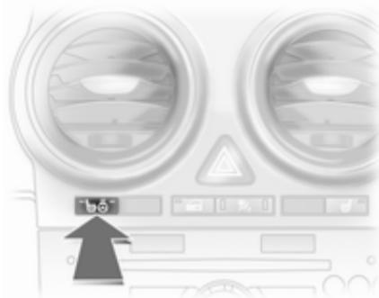
Attivare il riscaldamento in combinazione con il riscaldamento del sedile premendo il pulsante
