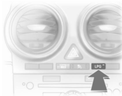
Premendo il pulsante **LPG** si passa dal funzionamento a benzina a quello a gas liquido e viceversa non appena i parametri richiesti (temperatura del
