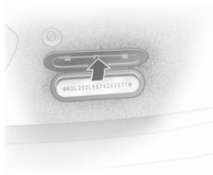
Il numero di telaio (VIN) si trova sulla targhetta di identificazione della vettura e sul sottoscocca, sotto la copertura del pianale, ed è visibile attraverso una protezione.
