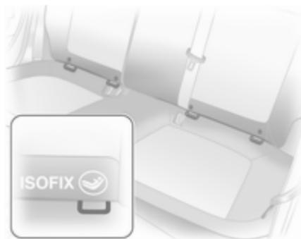
Fissare i sistemi di sicurezza ISOFIX per bambini, omologati per il veicolo in questione, alle staffe di montaggio.
