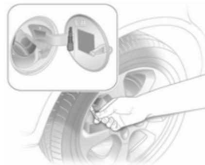
Pressione dei pneumatici ⇄ 219 ed etichetta all'interno dello sportellino di rifornimento del carburante.
