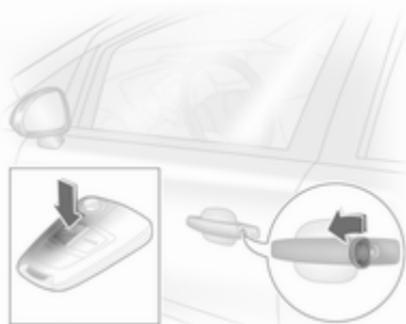
Girare la chiave nella serratura della portiera lato guida verso la parte anteriore oppure premere il pulsante ➤ per sbloccare le portiere e il vano di carico. Aprire le portiere tirando le maniglie. Per aprire il portellone posteriore, tirare il pulsante sotto la manodatura del portellone posteriore.
