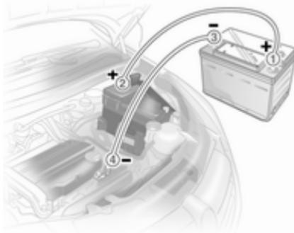
Disporre i cavi in modo che non si impiglino nelle parti in movimento all'interno del vano motore.
