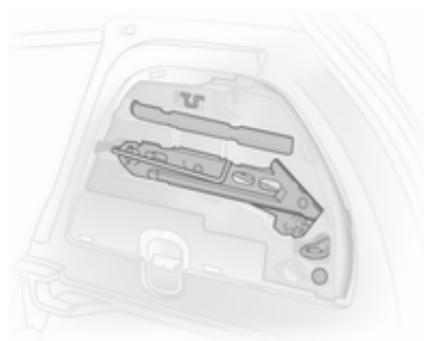
Il martinetto e gli attrezzi della vettura si trovano nel vano a destra del vano bagagli.
