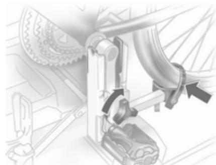
Serrare manualmente la vite del fissaggio del cuscinetto del pedale fino al punto massimo.
