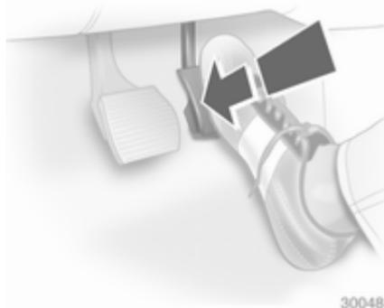
Premendo il pedale dell'acceleratore oltre il punto di resistenza, a seconda del regime del motore il cambio passa a una marcia inferiore.
