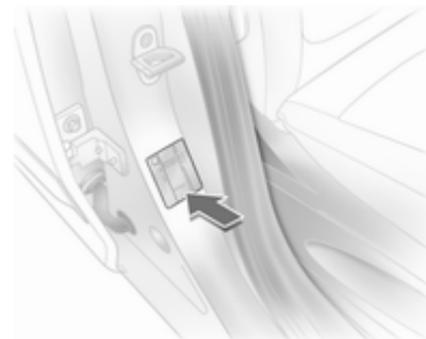
La targhetta di identificazione si trova nel telaio della portiera anteriore destra.
