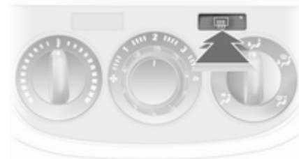
Si attiva premendo il pulsante
