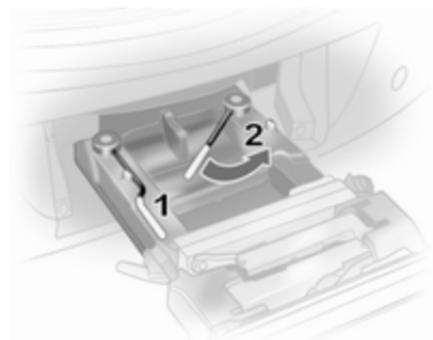
Ruotare prima la leva di bloccaggio sinistra (1), poi agire sulla leva destra (2) fino a quando si fermano. Entrambe le leve di bloccaggio devono essere rivolte all'indietro, in caso contrario non è garantita la sicurezza del funzionamento.
