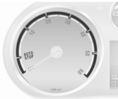
Indica la velocità di rotazione del motore.
