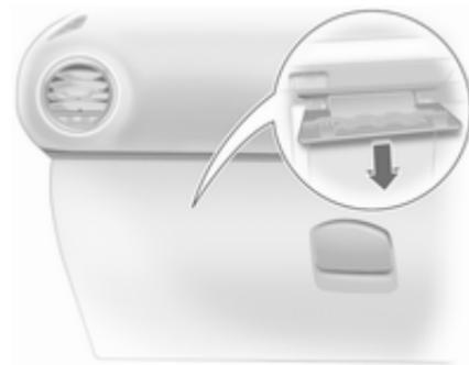
Sui veicoli con guida a destra, la scatola portafusibili si trova dietro un coperchio nel vano portaoggetti. Aprire il vano portaoggetti e rimuovere il coperchio. Per chiuderlo, prima posizionare la copertura, poi bloccarla in posizione.
