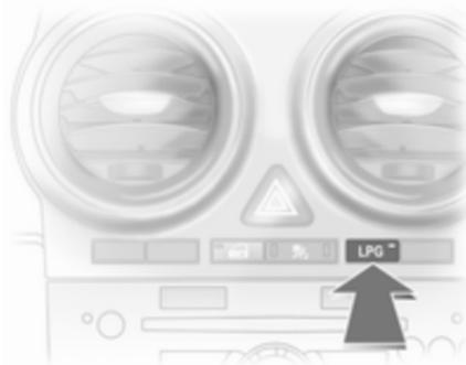
Premendo il pulsante **LPG** si passa dal funzionamento a benzina e quello a gas liquido e viceversa. Lo stato del LED
