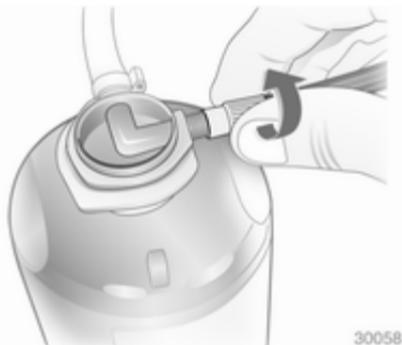
2. Staccare il tubo dell'aria dalla staffa e avvitarlo al raccordo della bombola.
