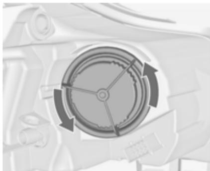
1. Ruotare la copertura protettiva **2** in senso antiorario e rimuoverla.
