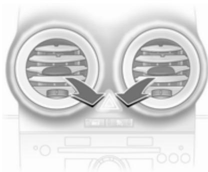
Regolare la direzione del flusso dell'aria ruotando la rotella di regolazione da destra a sinistra e sollevare oppure abbassare le alette orizzontali.
