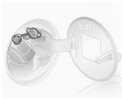
Montare l'adattatore necessario.
