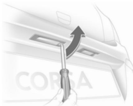
1. Inserire un cacciavite nell'alloggiamento della lampadina, premere verso il lato e rilasciare la molla.
