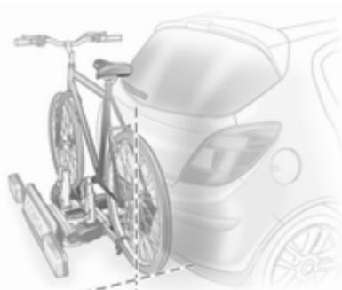
Allineare la bicicletta nella direzione longitudinale del veicolo. Allentare leggermente il fissaggio del pedale.
