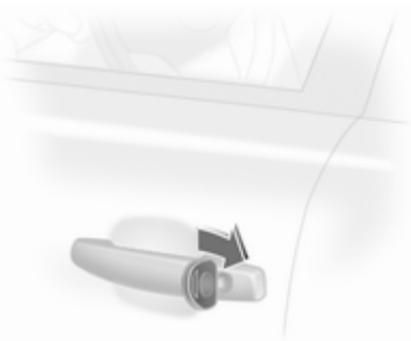
Girare la chiave nella serratura della portiera del conducente verso la parte posteriore.
