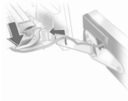
Premere la leva di bloccaggio verso il basso e premere il supporto della lampada nel fermo fino a quando si blocca.
