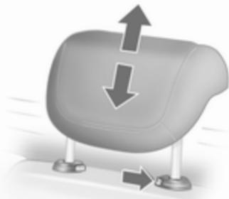
È possibile regolare l'altezza del poggiatesta in due posizioni. Per eseguire la regolazione nella prima posizione, tirare il poggiatesta verso l'alto. Per la seconda posizione, premere la molla indicata nell'illustrazione e portare il poggiatesta verso l'alto il più possibile. Per eseguire la regolazione verso il basso, premere la molla indicata nell'illustrazione e spingere il poggiatesta verso il basso.
