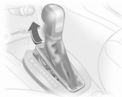
2. Staccare la parte anteriore del rivestimento della leva selettoria dalla consolle centrale, sollevarlo e ruotarlo verso sinistra.
