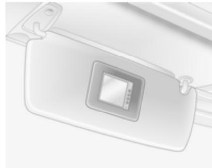
La videocamera viene generalmente montata sotto alla modanatura della targa con un monitor montato sull'alletta del parasole del conducente.
