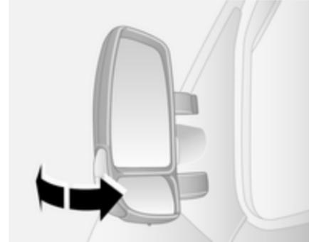
Per la sicurezza dei pedoni, gli specchietti retrovisori esterni fuoriescono dalla normale posizione di montaggio se vengono colpiti con forza sufficiente. Per riposizionare lo specchietto è sufficiente esercitare una leggera pressione sul corpo dello stesso.
