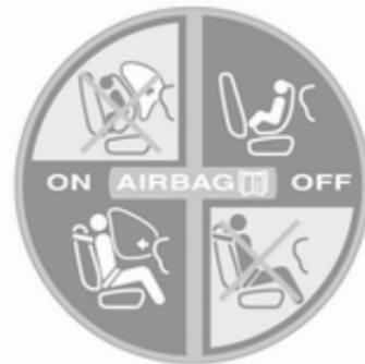
Per disattivare il sistema airbag del passeggero anteriore è necessario intervenire sull'interruttore ubicato sul lato del cruscotto.
