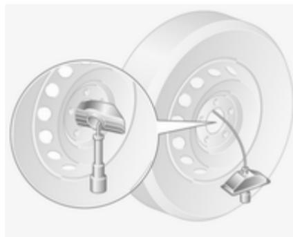
Mettere la ruota in posizione verticale, rimuovere il perno dal relativo fermo e sganciare il cavo.
