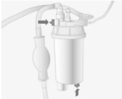
Eliminare l'acqua dal filtro diesel ad ogni sostituzione dell'olio motore.
