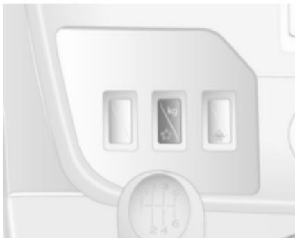
La modalità Laden può essere utilizzata sia in modalità manuale che in quella automatica. In entrambi i casi, la configurazione di innesto delle marce verrà automaticamente regolata per adattarsi all'aumento di carico utile.
