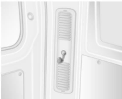
Il collegamento di accessori elettrici a motore spento può scaricare la batteria. Non superare il consumo massimo di corrente di 120 watt. Non collegare accessori che generano corrente, come, ad esempio, caricabatterie o batterie.
