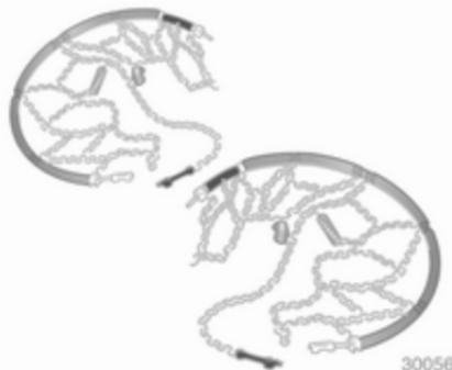
Il montaggio delle catene da neve è consentito soltanto sulle ruote motrici. Nei veicoli con ruote posteriori
