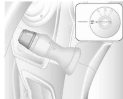
Quando la funzione di controllo automatico dei fari è attivata e il motore è acceso, il sistema alterna le luci diurne (se presenti) ed i fari a seconda delle condizioni di luminosità.
