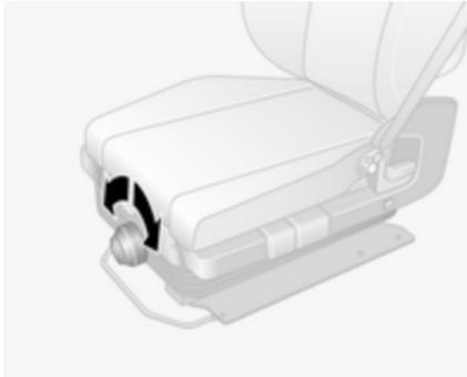
Ruotare la manopola per regolare il grado di sensibilità del sedile con molleggio.
