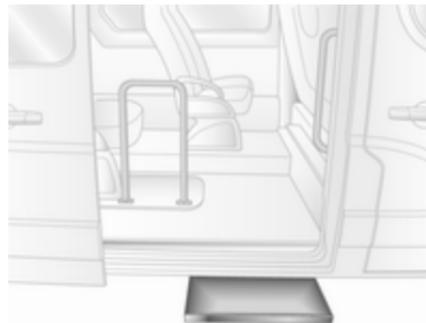
Il gradino laterale elettrico funziona automaticamente quando la porta scorrevole elettrica viene aperta o chiusa.
