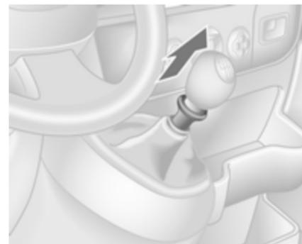
Retromarcia: con il veicolo fermo, premere il pedale della frizione, quindi sollevare il collare sulla leva del cambio e innestare la marcia.
