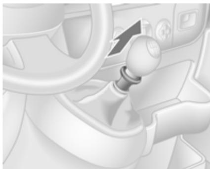
Per inserire la retromarcia, premere il pedale della frizione a veicolo fermo, sollevare il collare sulla leva del cambio e inserire la marcia.
