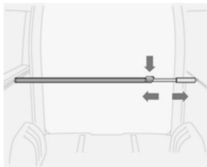
È possibile utilizzare le barre telescopiche di bloccaggio in posizione verticale oppure orizzontale.
