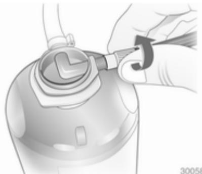
3. Avvitare il flessibile dell'aria del compressore sul raccordo della bombola del sigillante.
