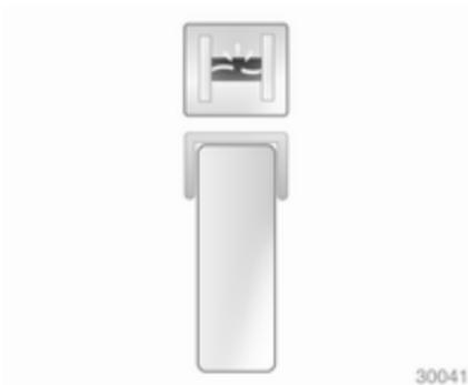
Un fusibile bruciato si riconosce dal filamento interrotto. Sostituire il fusibile solo dopo aver eliminato la causa del guasto.
