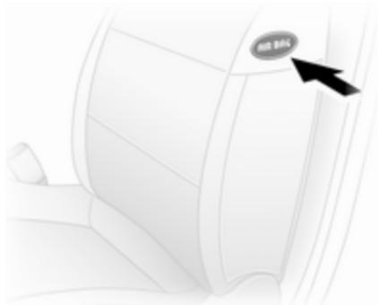
Il sistema airbag laterale è composto da un airbag nello schienale di ciascun sedile anteriore. La loro presenza viene segnalata dalla scritta **AIRBAG**.
