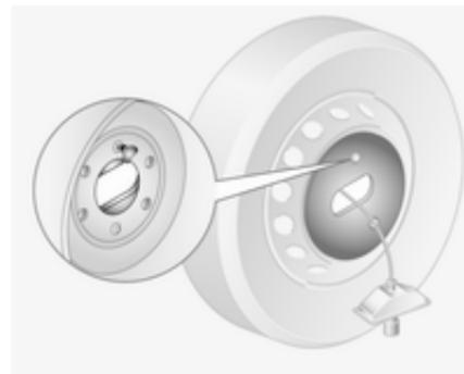
Prima di riporre nuovamente la ruota di scorta, montare la piastra di montaggio e fissarla con il dado.
