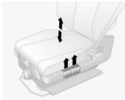
Tirare verso l'alto la leva anteriore per regolare l'altezza della parte anteriore del sedile.
