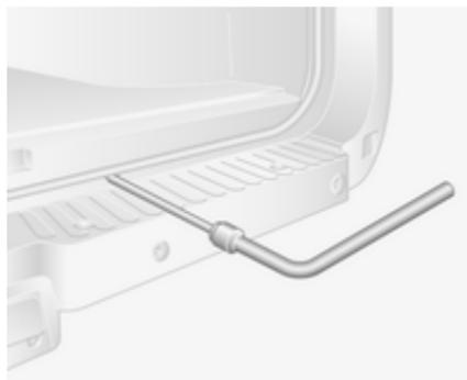
Per sganciare la ruota di scorta, allentare il cavo utilizzando la chiave per ruote con l'adattatore e abbassare completamente la ruota.
