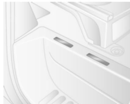
Il numero di telaio (VIN) è inoltre riportato sotto un coperchio rimovibile di plastica sul gradino della portiera anteriore destra. Sganciare le coperture con un cacciavite a taglio per avere accesso.
