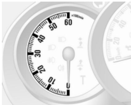
Indica la velocità di rotazione del motore.
