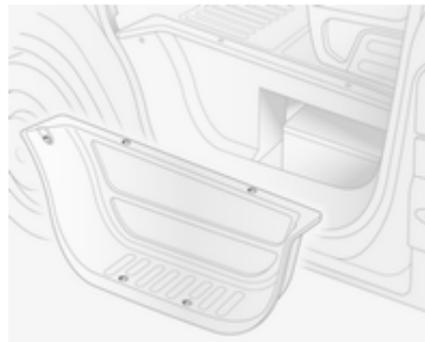
La batteria si trova sotto il veicolo, dietro a un pannello nel gradino della portiera anteriore sinistra. Smontare il pannello per accedere alla batteria.
