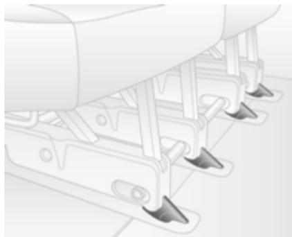
Posizionare le guide del sedile subito dietro i punti anteriori di ancoraggio al pavimento e farlo scorrere in avanti fino a che si blocca.
