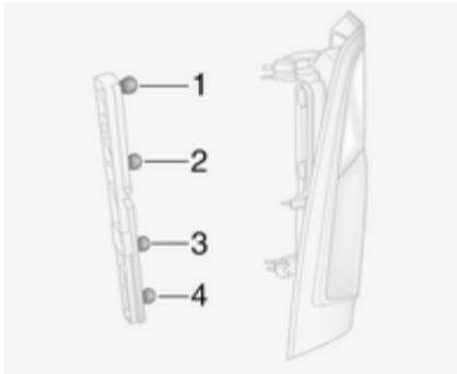
7. Esercitare una leggera pressione sulla lampadina nel portalampada, ruotare in senso antiorario, smontarla e sostituirla.
