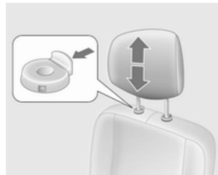
Tirare il meccanismo di sblocco verso l'alto per sollevare oppure premerlo per abbassare il poggiatesta. Verificare che il poggiatesta si blocchi.
