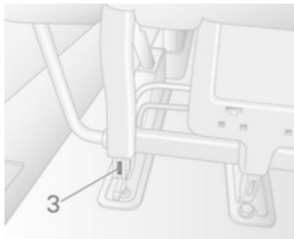
Il sedile si blocca automaticamente e i perni **3** non sono più visibili ad indicare l'avvenuto bloccaggio.
