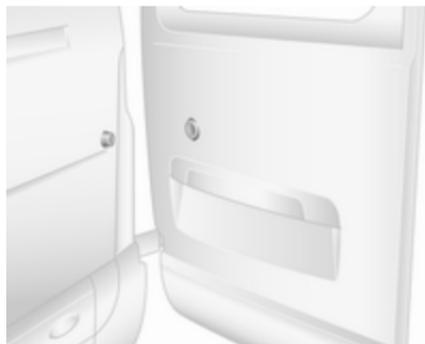
Se aperte a 270°, le portiere vengono mantenute in posizione da magneti sulla carrozzeria.
