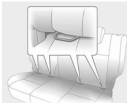
Fissare i sistemi di sicurezza per bambini ISOFIX omologati per il veicolo in questione ISOFIX alle staffe di montaggio.
