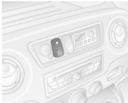
Dopo aver inserito il freno di stazionamento, premere l'interruttore posto nel cruscotto per aprire automaticamente la porta scorrevole elettrica; durante l'operazione, il LED nell'interruttore lampeggia.
