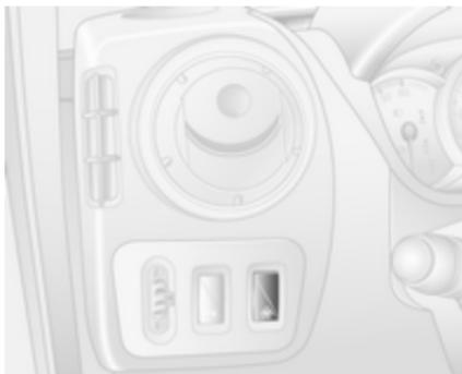
Quando si richiede lo slittamento delle ruote motrici, il sistema ESP®Plus può essere disattivato.
