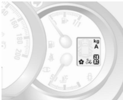
Il display del cambio visualizza la modalità o la marcia innestata del cambio manuale automatizzato.
