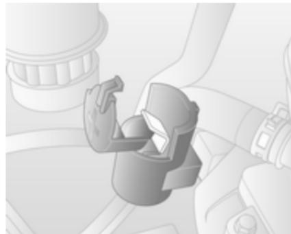
Se la batteria è scarica, il terminale per l'avviamento di emergenza consente l'avviamento del veicolo senza dover accedere alla batteria all'interno del veicolo.
