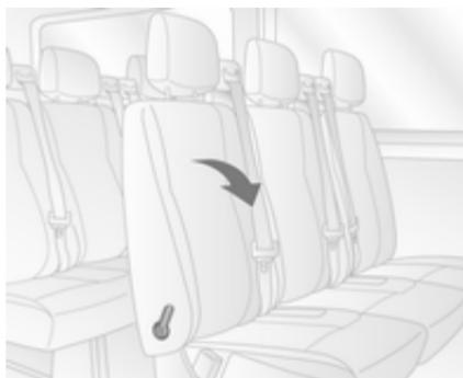
Per agevolare l'accesso ai sedili posteriori, tirare la leva di sbloccaggio e piegare lo schienale in avanti.
