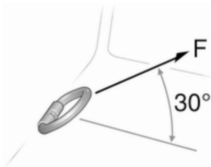
Il vano di carico è dotato di occhielli di ancoraggio per consentire il fissaggio del carico con cinghie o rete di contenimento.
