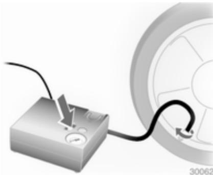
17. Mettersi immediatamente in marcia, in modo da distribuire uniformemente il sigillante nel pneumatico. Dopo aver percorso circa 10 km, non oltre 10 minuti di viaggio), fermarsi e controllare la pressione dei pneumatici con il compressore. Nel fare questo, avvitare direttamente il tubo dell'aria del compressore sulla valvola del pneumatico.
