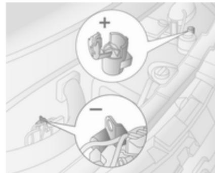
8. Collegare il cavo di alimentazione **+** del compressore al terminale di avviamento di emergenza con i cavetti ⇨ 153.
