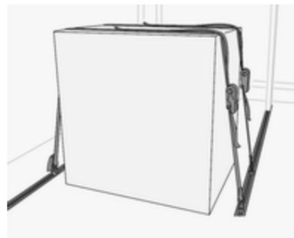
Utilizzando le cinghie di ancoraggio, fissare l'oggetto agli occhielli di ancoraggio smontabili presenti nel pavimento del veicolo.
