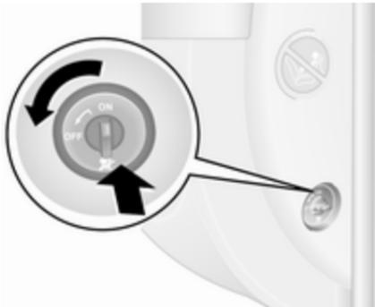
Con la portiera anteriore aperta, premere l'interruttore e ruotarlo in senso antiorario in posizione **OFF**.
