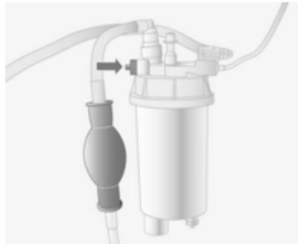
Se il serbatoio del carburante si è svuotato, è necessario spurgare l'impianto di alimentazione del diesel.
