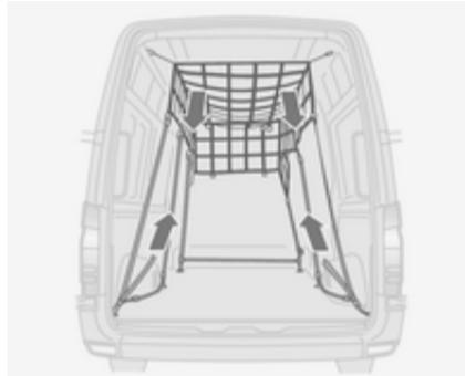
Abbassare la rete di sicurezza dalla zona del tetto e attaccarla agli occhielli di ancoraggio ↪ 59.
