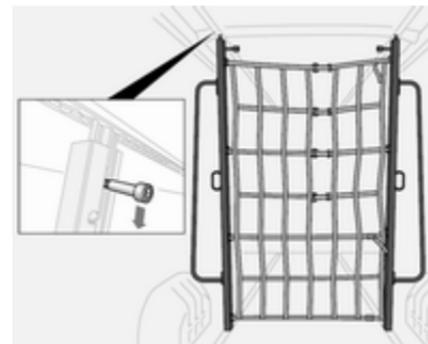
Per muoverla, abbassare la chiusura per rilasciare e posizionare la parete come richiesto. Assicurarsi che la chiusura si blocchi completamente e che la parete di separazione sia dritta.
