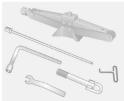
Martinetto, chiave per le ruote, adattatore, gancio per coprimozzo, chiave e occhiello di traino sono riposti in un contenitore sotto il sedile anteriore.
