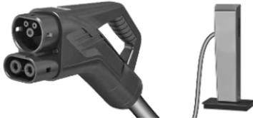
Il tempo di ricarica può variare in base alla stazione di ricarica: le stazioni di ricarica CC garantiscono la ricarica più rapida. Per caricare la batteria del veicolo, il cavo di carica della stazione deve essere collegato alla presa di ricarica del veicolo.
