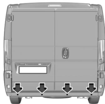
Quando la retromarcia è innestata, il sistema segnala acusticamente al conducente la presenza di ostacoli potenzialmente pericolosi dietro il veicolo, entro un raggio massimo di 50 cm.
