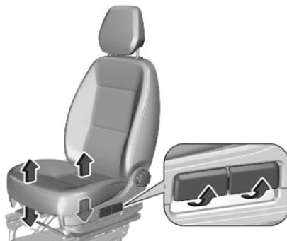
Tirare verso l'alto la leva anteriore per regolare l'altezza della parte anteriore del sedile.
