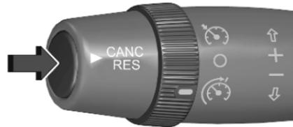
Premere il pulsante per azionare il sistema con l'ultima velocità programmata.
