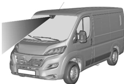
L'allarme collisione anteriore utilizza la telecamera anteriore nel parabrezza per rilevare un veicolo che precede direttamente sul percorso del veicolo.
