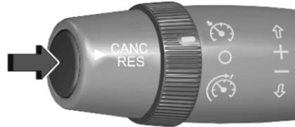
Premere il pedale del freno, il pedale della frizione o premere il pulsante. Il controllo automatico della velocità di crociera è in modalità di pausa. Si sta guidando il veicolo senza il controllo automatico della velocità di crociera.
