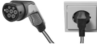
La batteria ad alta tensione del veicolo può essere ricaricata in una presa elettrica domestica. Collegare il cavo di carica alla presa di ricarica del veicolo e alla presa elettrica domestica.
