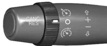
Ruotare la manopola su 0 per disattivare il sistema.
