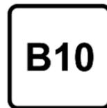
Carburante diesel conforme alla norma EN16734 mescolato con un biocombustibile conforme alla norma EN14214 (possibilmente con una percentuale di estere metilico di acidi grassi superiore al 10%)
