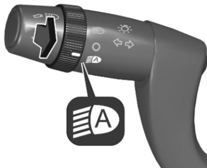
Ruotare la manopola di regolazione in posizione
