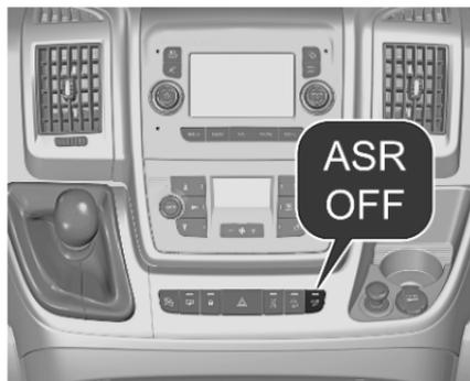
Il sistema TC può essere disattivato ogni volta necessaria: premere **ASR OFF**.
