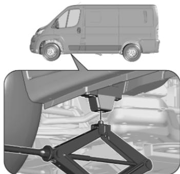
3. Controllare che il martinetto sia in posizione corretta sotto il relativo punto di sollevamento del veicolo vicino alla ruota anteriore.
