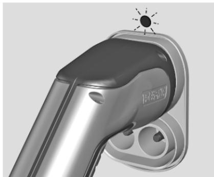
Il LED posizionata sopra la presa di carica si illumina per indicare che la spina del veicolo è bloccata.
