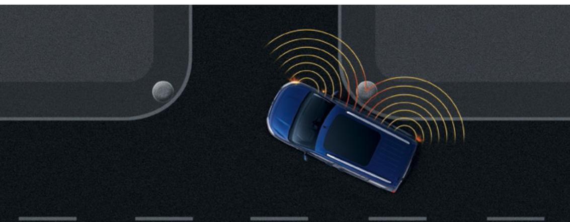
Sistema di protezione della fiancata (Flank Guard)
