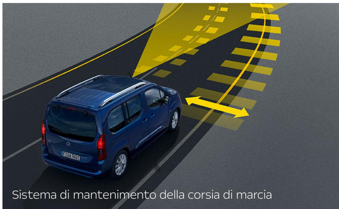
Sistema di mantenimento della corsia di marcia
