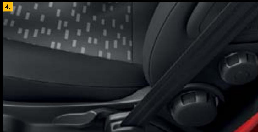
**4. Sedile con regolazione del sostegno lombare.** Il sedile del guidatore regolabile su sei posizioni (a richiesta) è dotato anche di regolazione del sostegno lombare e di bracciolo separato, in modo che chi siede al volante possa adattarlo meglio alla sua schiena.
