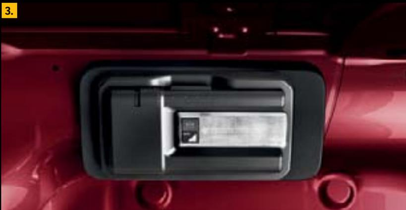
**3. Torcia estraibile.** All'estremità superiore destra del vano di carico, una torcia estraibile utile quando ci si trova a lavorare in ambienti bui.
