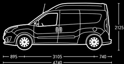
Cargo con passo lungo e tetto alto.
