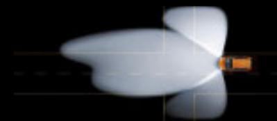
**Luce statica in curva (fino a 40 km/h).** Dopo aver inserito l'indicatore di direzione e aver sterzato oltre un angolo specifico, un LED migliora la visibilità in curva.
