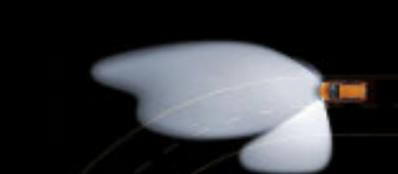
**Illuminazione dinamica in curva (da 40 a 70 km/h).** Oltre un determinato angolo di sterzata e una certa velocità, viene illuminata la superficie stradale laterale per avere una visibilità migliore.
