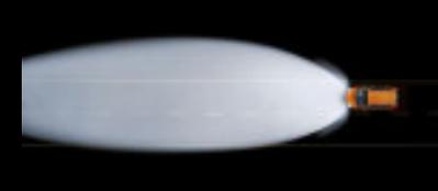
**Assistenza abbaglianti.** Massima illuminazione e massima visibilità. Il sistema abbassa automaticamente gli abbaglianti in presenza di altri veicoli.
