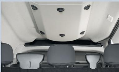
**Condizionamento parte posteriore su Combi.** Il condizionamento separato della parte posteriore, con bocchette posizionate in alto, assicura un clima gradevole per i passeggeri in seconda e terza fila (disponibile a richiesta).
