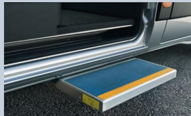
**Pedana laterale a scomparsa.** La pedana che scorre elettricamente verso l'esterno del veicolo e una maniglia interna di sostegno facilitano l'ingresso e l'uscita dei passeggeri dall'abitacolo (di serie su Movano Bus).
