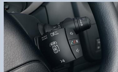
**Comandi al volante per regolare l'impianto audio.** Permettono di attivare tutte le principali funzioni della radio (regolazione del volume, selezione delle emittenti) senza togliere le mani dal volante.
