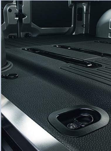
**Anelli di fissaggio carico (Combi).** Sulla superficie del vano del bagagliaio, anelli pratici e funzionali consentono di fissare agevolmente il carico all'interno.
