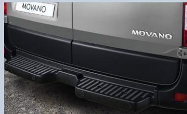
**Pedana posteriore.** La pedana posteriore, all'interno del paraurti, facilita l'accesso al vano di carico di Movano Combi (disponibile a richiesta).
