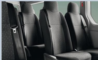
**Sedili comfort.** Movano migliora il comfort dei suoi sedili, ad esempio portando l'angolo di inclinazione degli schienali da 13° a 19,5°. Inoltre, i sedili di Movano offrono ampio spazio alle gambe e alle spalle dei passeggeri, con cinture di sicurezza a tre punti.
