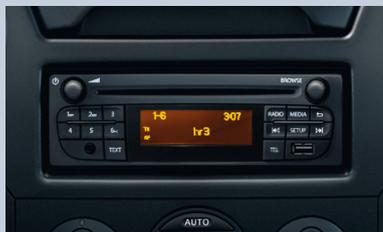
**Radio CD 16 BT USB.** Lettore CD/MP3, connessione Bluetooth®, 2 prese USB, presa aux-in e display integrato. Potenza 2 x 15 Watt (Bus) o 4 x 15 Watt (Combi).
