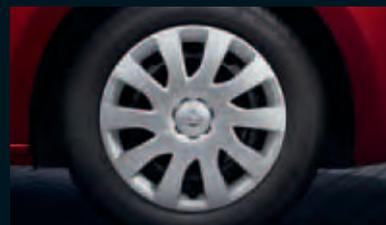
Cerchi in acciaio da 16" a 5 razze con copripuota integrali a 10 raggi, 6 J x 16", pneumatici 215/65 R 16 (QP9)<sup>1</sup>.
